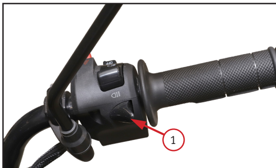
Фото 2.3. Левый комбинированный переключатель (вид спереди): 1 – кнопка включения дальнего света при обгоне
