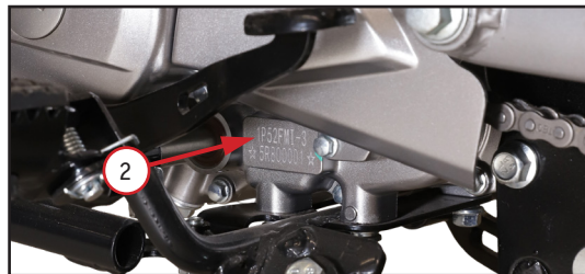
Фото 1.2. Слева на карте нанесен серийный номер двигателя 2
