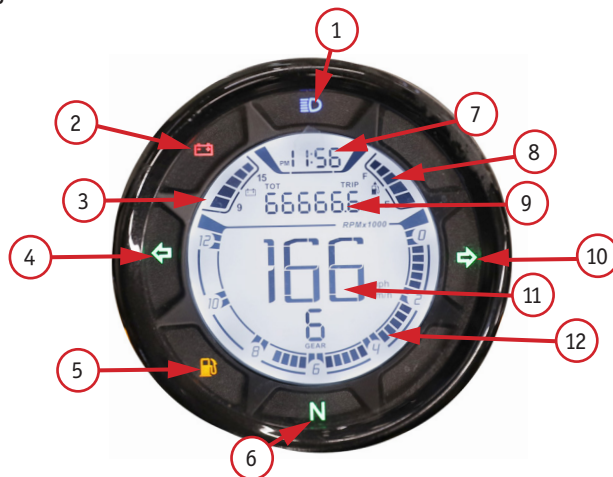
Фото 2.10. Вид приборной TFT-панели: 1 – индикатор дальнего света; 2 – сигнал низкого напряжения батареи; 3 – напряжение батареи; 4 – левый поворотник; 5 – сигнал низкого уровня топлива; 6 – индикатор нейтрالي; 7 – часы; 8 – указатель уровня топлива; 9 – одометр; 10 – правый поворотник; 11 – спидометр; 12 – тахометр
