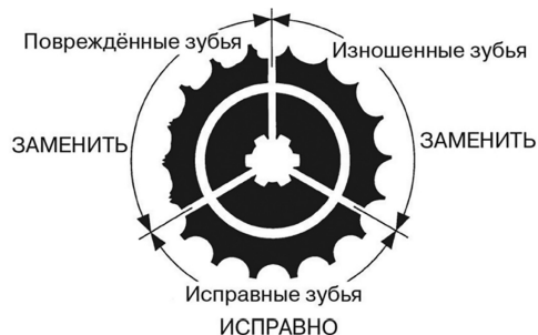
Рисунок 3. Вид зубьев звездочки
