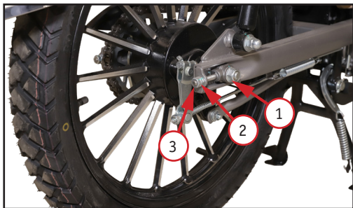
Фото 5.10. Регулировка натяжения цепи: 1 – гайка оси; 2 – регулировочный болт; 3 – стопорная гайка
