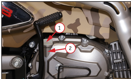
Фото 5.1. Контроль: 1 – щуп контроля уровня масла; 2 – заливная горловина
