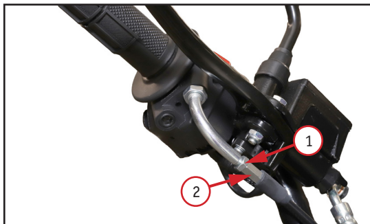
Фото 5.4. Регулировка троса газа: 1 – стопорная гайка; 2 – регулировочная гайка
