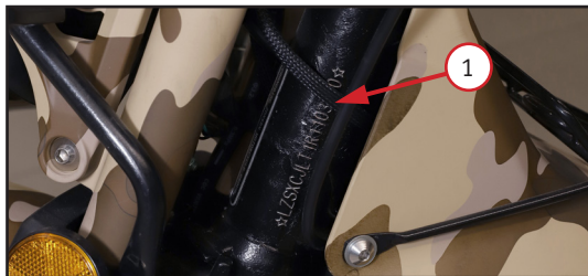
Фото 1.1. Идентификационный код транспортного средства (VIN) 1 нанесен слева на рулевом стекле
