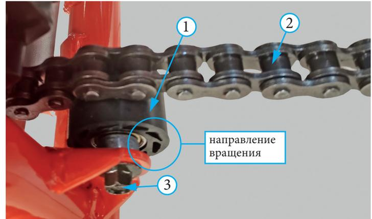
Фото 5.15. Ролик натяжителя цепи: 1 - ролик; 2 - цепь; 3 - винт крепления ролика
