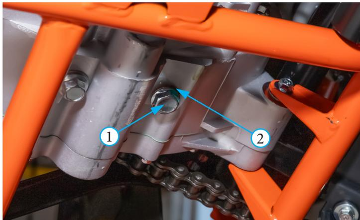
Фото 5.4.1 Слив масла из редуктора: 1 – болт сливного отверстия;
