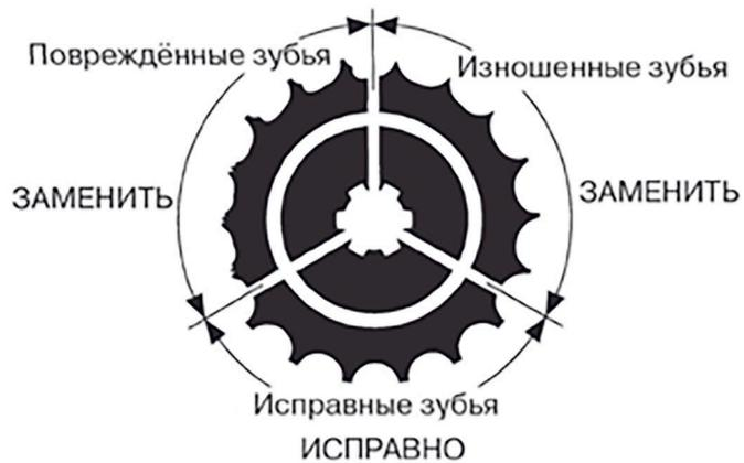
Рисунок 5.14. Вид зубьев звездочки
