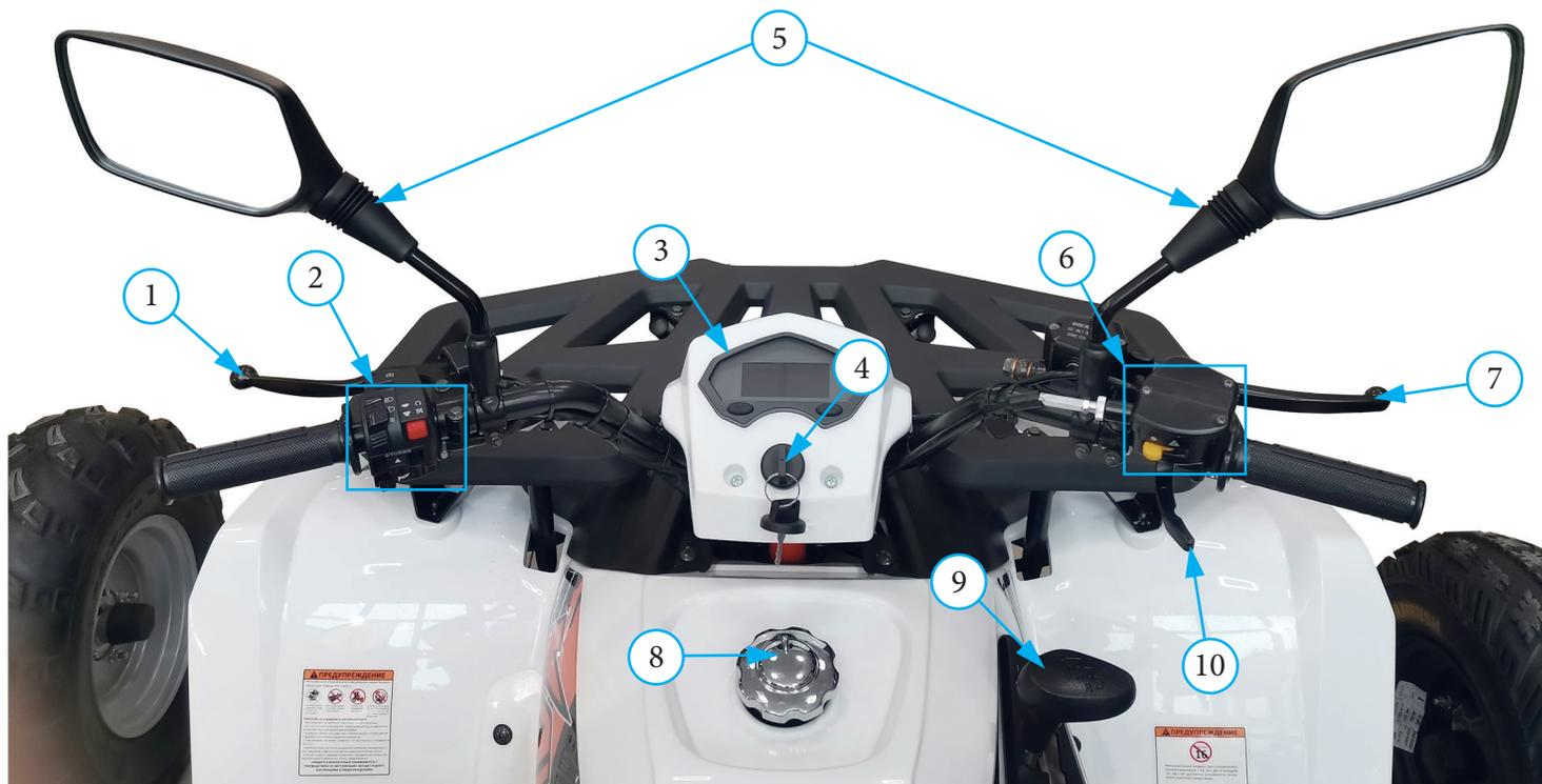
Фото 2.2.1 Приборы и органы управления квадрицикла (вариант): 1 – рычаг сцепления; 2 – левый рулевой блок; 3 – приборная панель; 4 – замок с ключом зажигания; 5 – зеркала заднего вида; 6 – правый рулевой блок; 7 – ручка переднего тормоза; 8 – крышка топливного бака; 9 – рычаг переключения передач; 10 – рычаг акселератора
