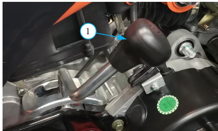
Фото 3.6. Рычаг переключения передач (ножной и ручной)
