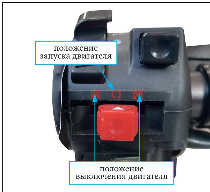
Фото 2.7. Символы левого рулевого блока квадрицикла (вариант):
