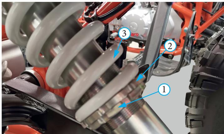
Фото 5.19. Преднатяг пружины заднего амортизатора:
