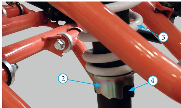
Фото 5.20. Преднатяг пружины переднего амортизатора
