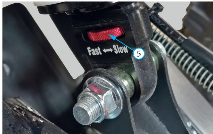
Фото 5.22. Гайка регулировки отбоя заднего амортизатора
