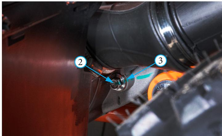
Фото 5.4.2 Залив масла в редуктор (левая сторона): болт 2 смотрового
