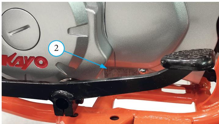
Фото 1.3. Место расположения серийного номера двигателя - 2
