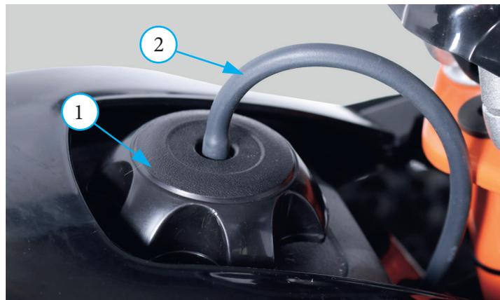
Фото 5.1. Крышка топливного бака - 1; трубка сапуна – 2
