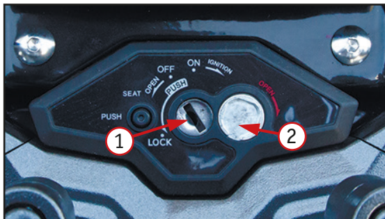
Фото 2.6. Комбинированный замок: 1 – замочная скважина; 2 – гнездо защитной шторки замка зажигания
