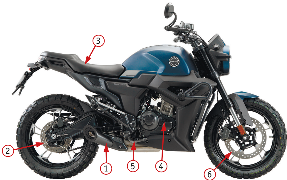
Фото 2.2. Вид справа: 1 – глушитель; 2 – задний тормозной диск; 3 – сиденье; 4 – заливная горловина для масла; 5 – педаль заднего тормоза; 6 – передний тормозной диск
