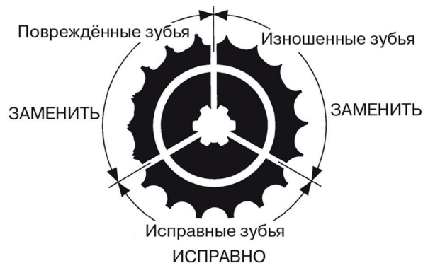
Рисунок 5.27. Вид зубьев звездочки
