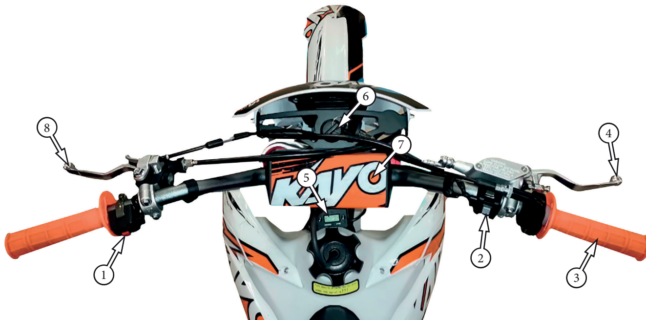
Фото 2.3. Приборы и органы управления (вариант): 1 – кнопка выключения двигателя; 2 – кнопка стартера; 3 – рукоятка акселератора; 4 – рычаг переднего тормоза; 5 – счетчик моточасов (приборная панель); 6 – замок зажигания; 7 – накладка на руль; 8 – рычаг сцепления
