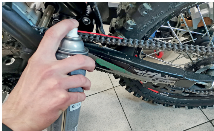
Фото 5.30. Очистка и смазка цепи
