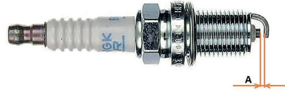
Фото 5.16. Зазор между электродами свечи зажигания
