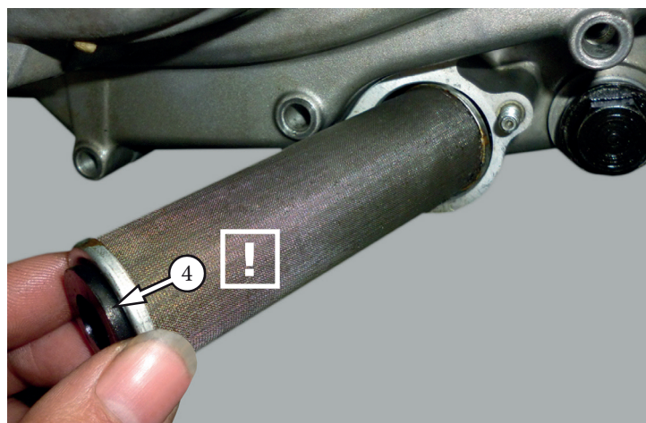
Фото 5.4. Замена масла в двигателях с масляным фильтром
