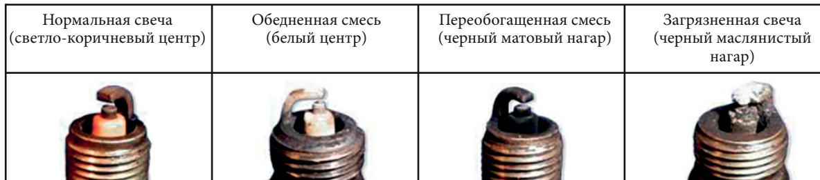
Фото 5.15. Состояния свечей зажигания
