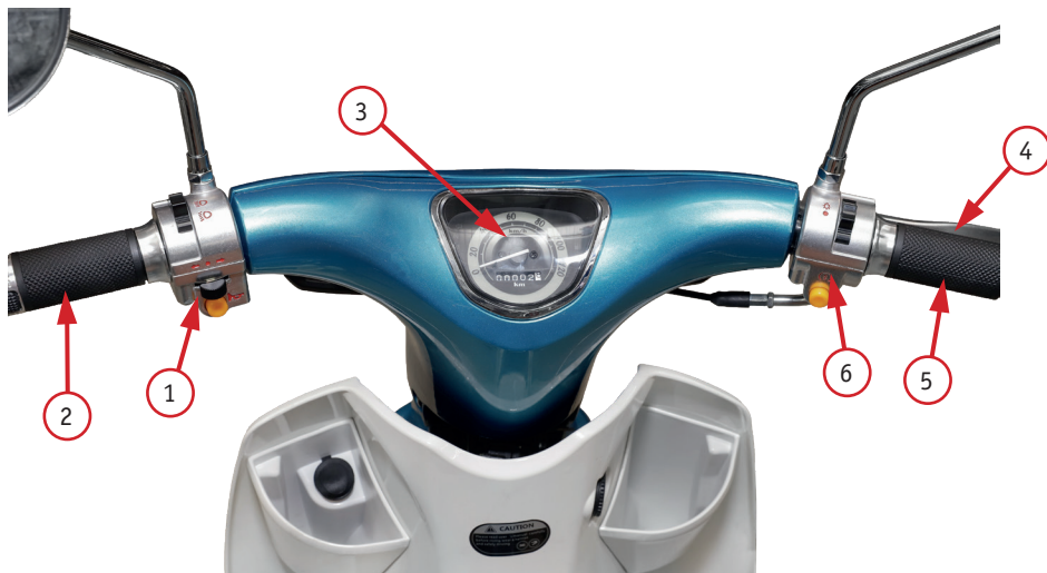
Фото 2.1. Вид руля и органов управления мотоцикла: 1 – левая рулевая рукоятка; 2 – левый комбинированный переключатель; 3 – приборная панель; 4 – правый комбинированный переключатель; 5 – рукоятка газа (акселератор); 6 – ручка переднего тормоза
