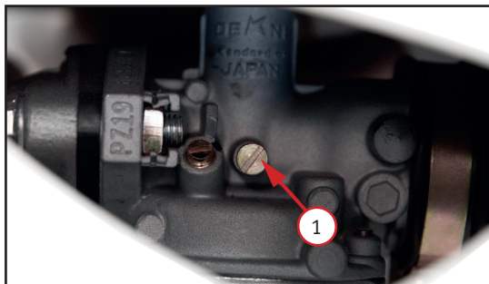
Фото 5.5. Регулировка холостых оборотов: винт регулировки холостых оборотов 1
