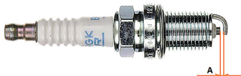
Фото 5.7. Зазор свечи зажигания «А»
