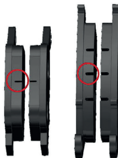
Фото 4.10. Износ тормозных колодок «А»
