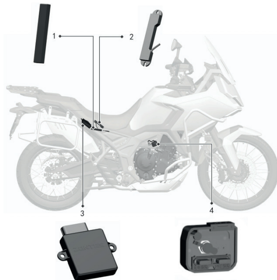
Фото 2.6. Система бесключевого доступа: 1 – приемо-передающая антенна; 2 – индуктивная антенна; 3 – блок РКЕ; 4 – порт зарядки с предохранителями
