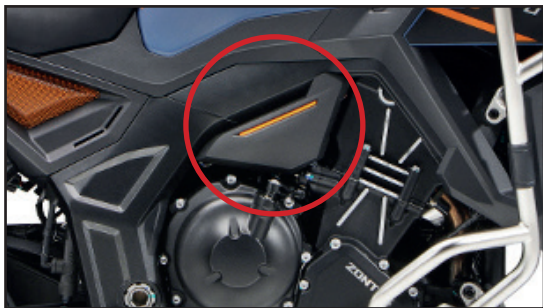
Фото 4.2 Место подключения зарядки АКБ: 1 – разъем зарядки
