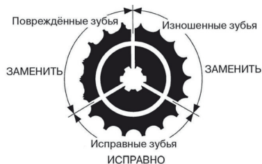
Рисунок 2. Износ звезд
