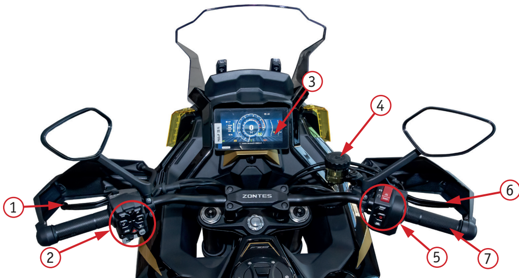
Фото 2.1. Вид руля и органов управления: 1 – рычаг сцепления; 2 – левый блок переключателей; 3 – приборная панель; 4 – бачок для тормозной жидкости передних тормозов; 5 – правый блок переключателей; 6 – ручка переднего тормоза; 7 – ручка газа (акселератора)
