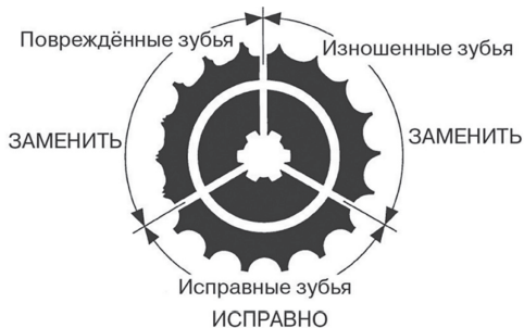
Рисунок 3. Вид зубьев звездочки
