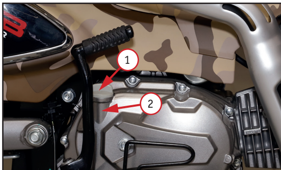
Фото 5.1. Контроль: 1 – щуп контроля уровня масла; 2 – заливная горловина
