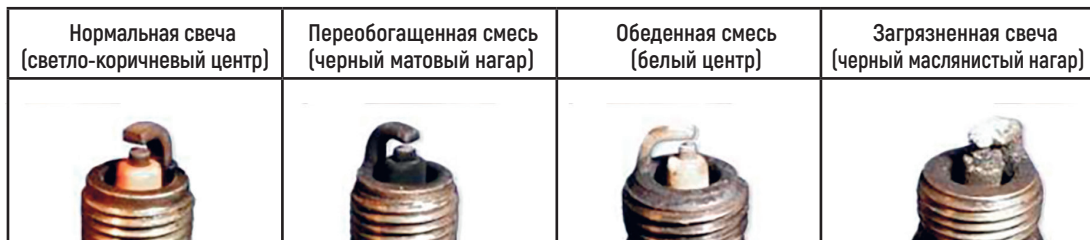
Фото 5.6. Состояния свечи зажигания
