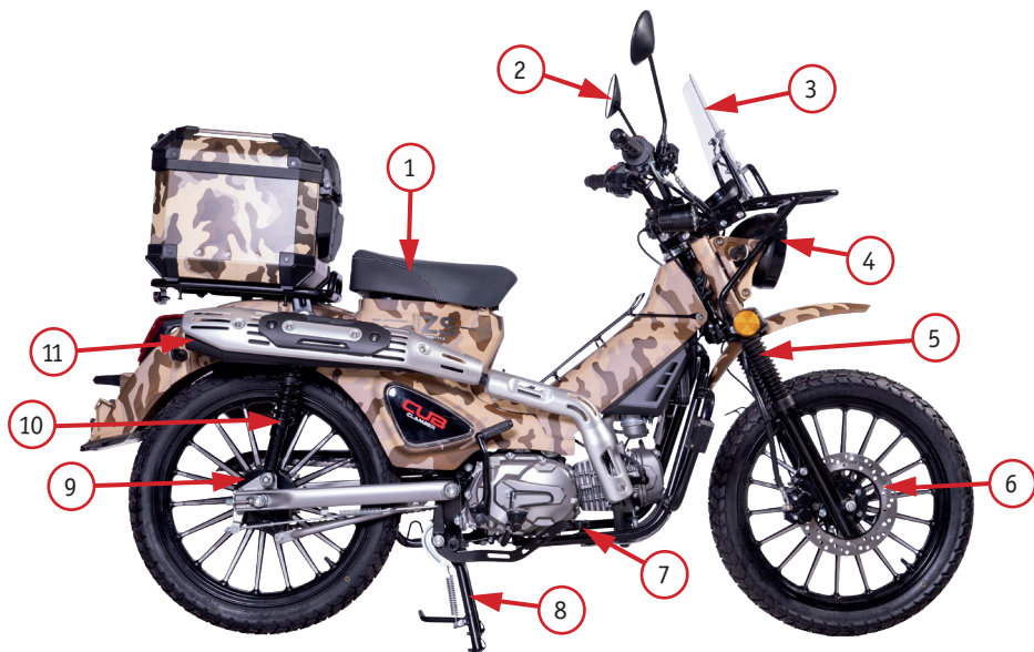
Фото 2.2. Вид мотоцикла: 1 – сиденье водителя; 2 – зеркало; 3 – ветровое стекло; 4 – фара; 5 – передний амортизатор; 6 – передний тормозной диск; 7 – педаль заднего тормоза; 8 – центральная подставка; 9 – задний тормозной суппорт; 10 – задний амортизатор; 11 – глушитель
