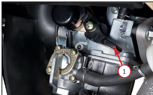
Фото 3.2. Рычаг воздушной заслонки (обогащения топливной смеси) – 1
