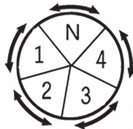
Рисунок 1. Схема переключения передач
