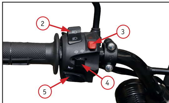
Фото 2.4. Левый комбинированный переключатель: 2 – переключатель дальнего/ближнего света; 3 – кнопка аварийной сигнализации; 4 – переключатель поворотников; 5 – кнопка сигнала (гудок)
