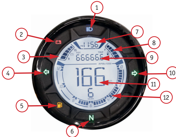
Фото 2.10. Вид приборной TFT-панели: 1 – индикатор дальнего света; 2 – сигнал низкого напряжения батареи; 3 – напряжение батареи; 4 – левый поворотник; 5 – сигнал низкого уровня топлива; 6 – индикатор нейтрالي; 7 – часы; 8 – указатель уровня топлива; 9 – одомер; 10 – правый поворотник; 11 – спидометр; 12 – тахометр
