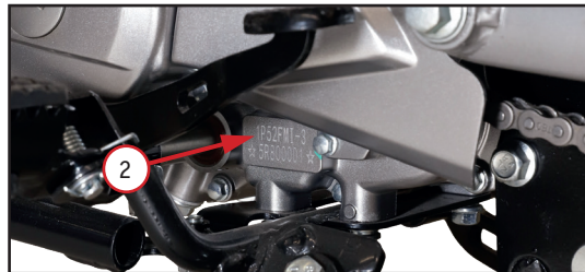
Фото 1.2. Слева на картере нанесен серийный номер двигателя 2
