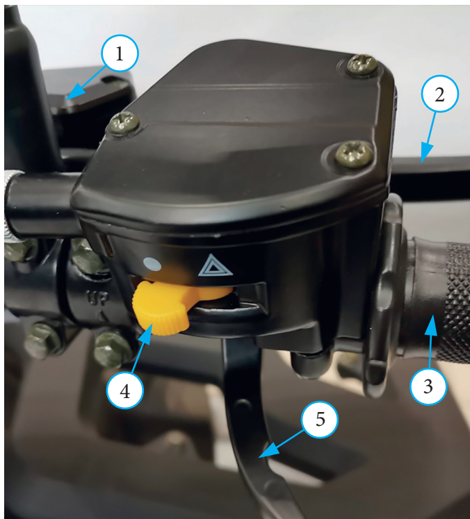
Фото 2.5.1 Переключатели правого рулевого блока квадрицикла (вариант): 1 – бачок переднего тормоза; 2 – рычаг переднего тормоза; 3 – правая ручка; 4 – включатель аварийных сигналов; 5 – рычаг акселератора
