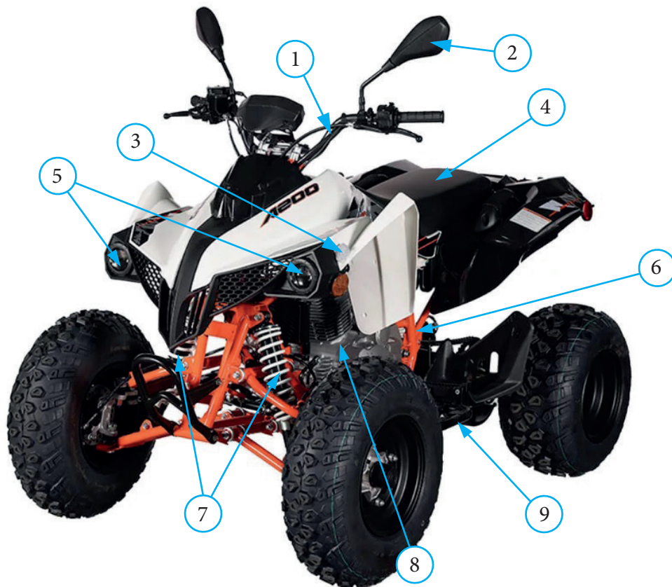
Фото 2.1. Левая сторона квадрицикла А200: 1 – руль с органами управления; 2 – зеркало заднего вида; 3 – передний указатель поворота; 4 – сиденье; 5 – передние фары; 6 – рама; 7 – передняя подвеска; 8 – двигатель; 9 – левая подножка водителя
