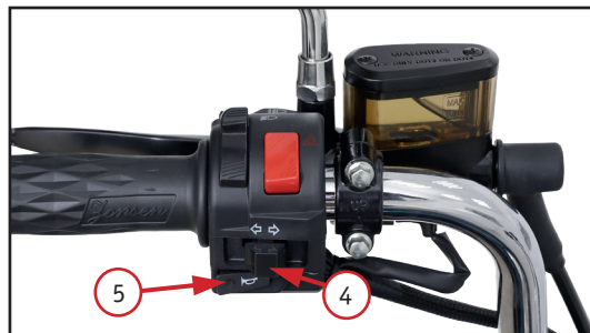
Фото 2.3. Левый комбинированный переключатель: 1 – кнопка включения дальнего света при обгоне; 2 – переключатель дальнего/ближнего света; 3 – кнопка аварийной сигнализации; 4 – переключатель поворотников; 5 – кнопка сигнала (гудок)
