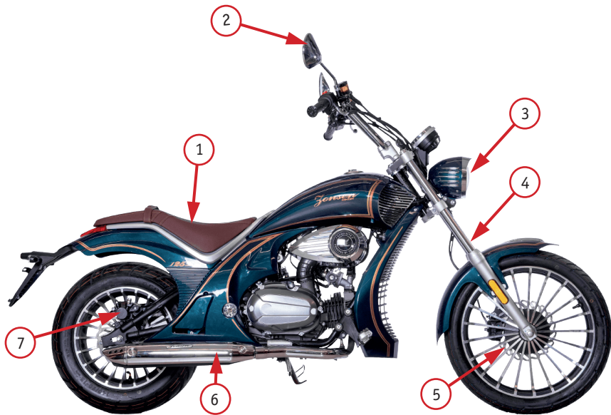
Фото 2.2. Вид мотоцикла: 1 - сиденье водителя; 2 – зеркало; 3 – фара; 4 – передний амортизатор; 5 – передний тормозной диск; 6 – глушитель; 7 – задний тормозной суппорт
