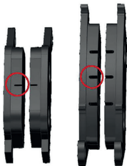
Фото 4.11. Износ тормозных колодок «А»
