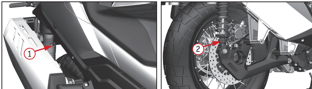
Фото 2.22. Настройка задней подвески: 1 – регулировка преднатяга пружины; 2 – регулировка демпфирования отбоя
