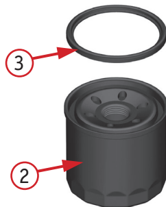
Фото 4.7. Замена масляного фильтра: 1 – защита фильтра; 2 – масляный фильтр; 3 – уплотнительное кольцо
