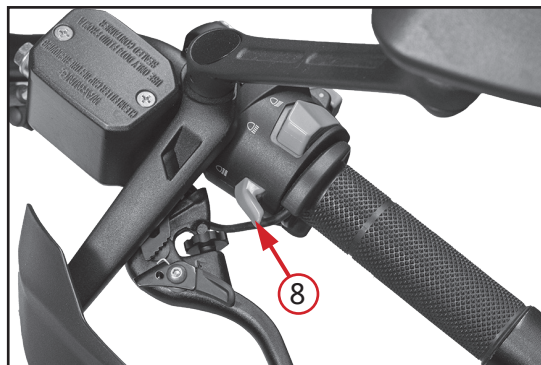
Фото 2.4. Левый блок переключателей: 1 – переключатель режима света фары (дальний/ближний); 2 – кнопка включения аварийной сигнализации; 3 – кнопка «SET»; 4 – кнопка «MOD»; 5 – переключатель противотуманных фар; 6 – кнопка звукового сигнала; 7 – переключатель указателей поворотов; 8 – кнопка дальнего света при обгоне
