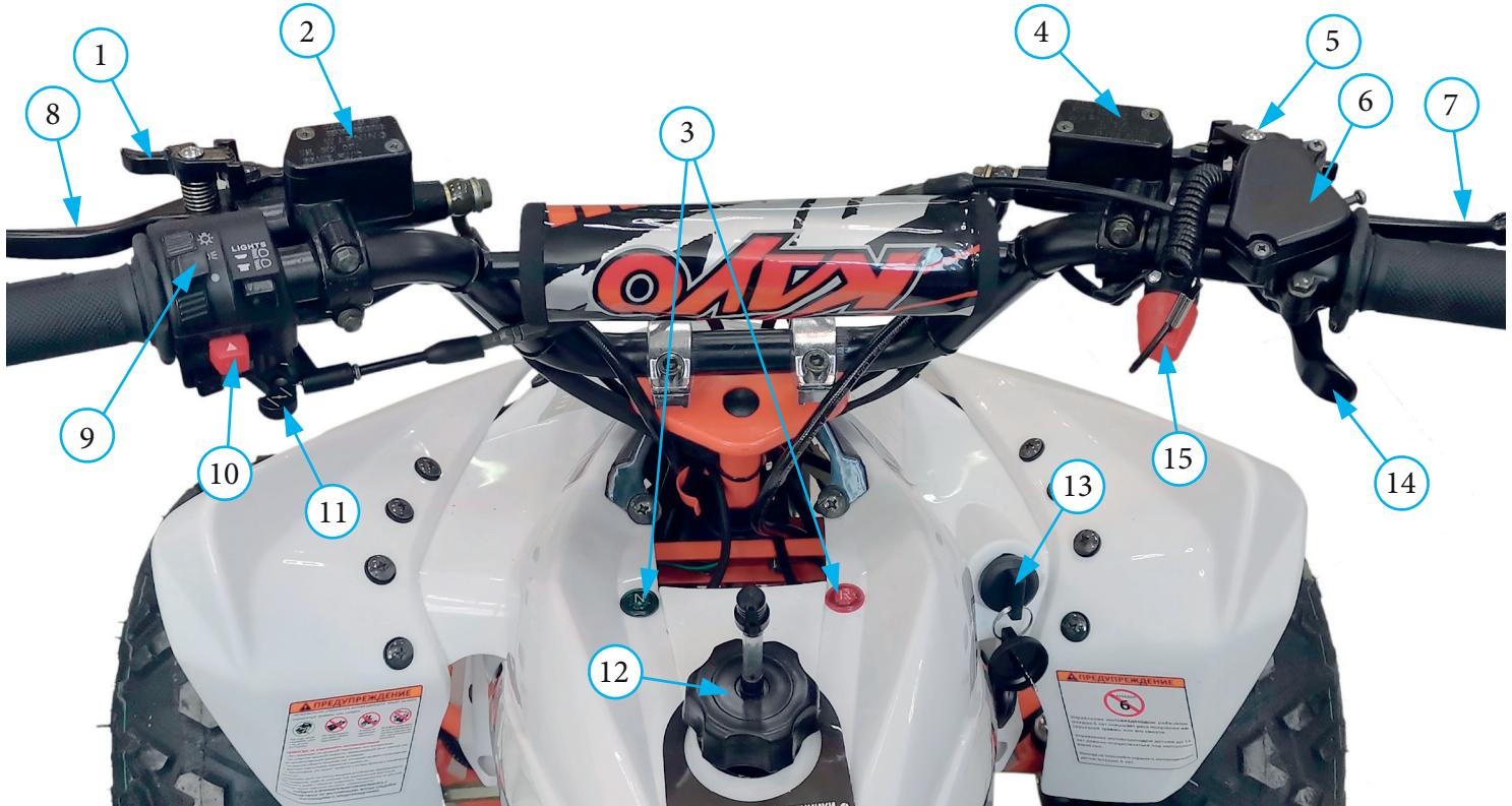
Фото 2.2. Приборы и органы управления комплекта запчастей: 1 - фиксатор стояночного заднего тормоза;
