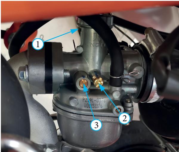
Фото 5.5 Регулировка карбюратора:
