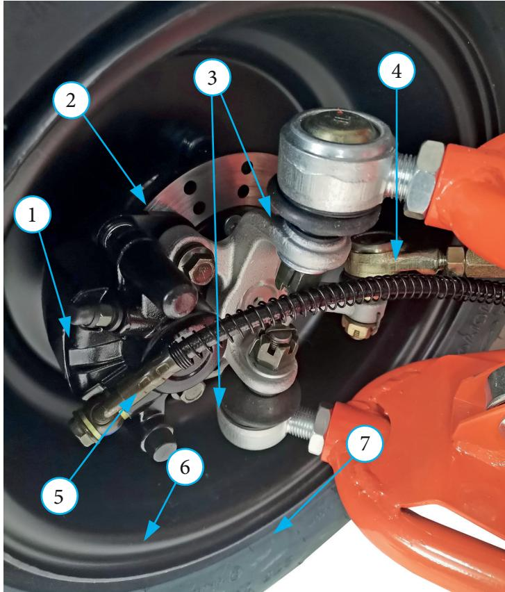
Фото 2.4. Узел поворотного кулака: 1 - передний тормозной суппорт;
