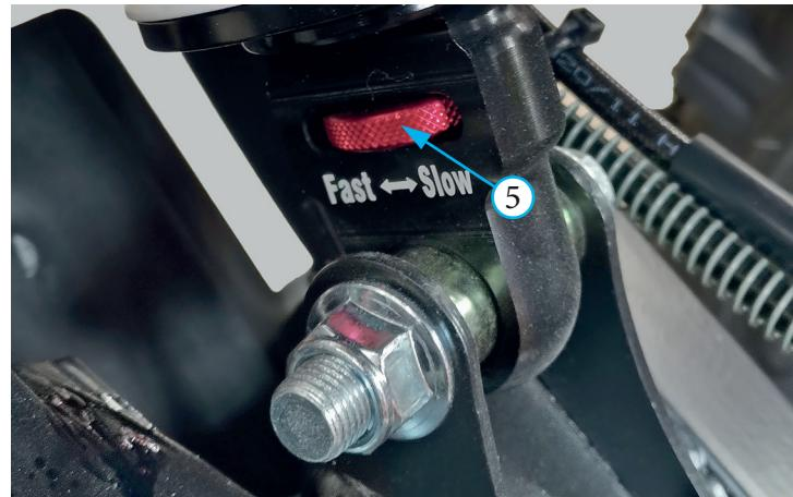
Фото 5.22. Гайка регулировки отбоя заднего амортизатора
