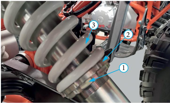
Фото 5.19. Преднатяг пружины заднего амортизатора:
