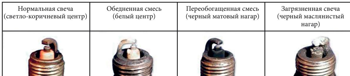
Фото 5.8. Состояния свечи зажигания
