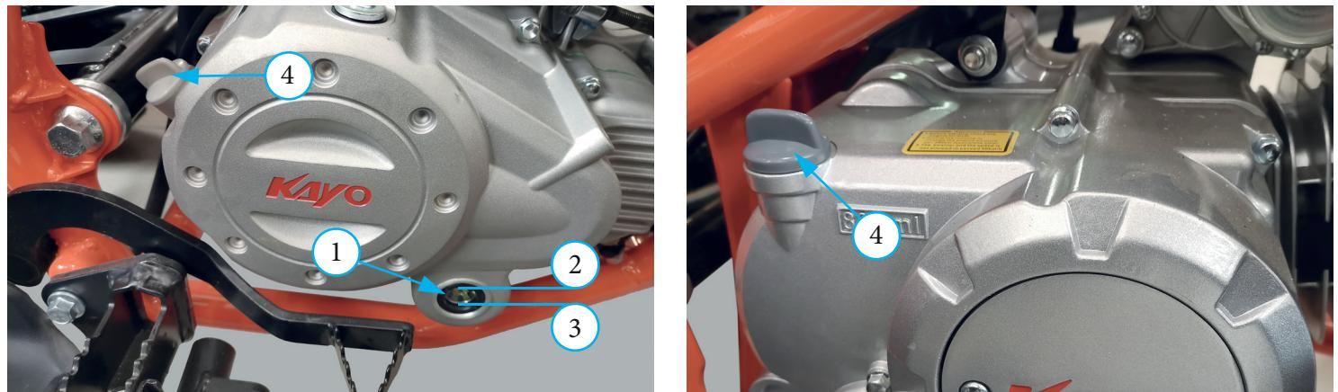
Фото 5.2. Варианты исполнения смотрового окна и крышки горловины двигателей:
