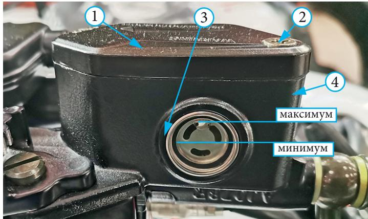
Фото 5.10. Контроль тормозной жидкости
