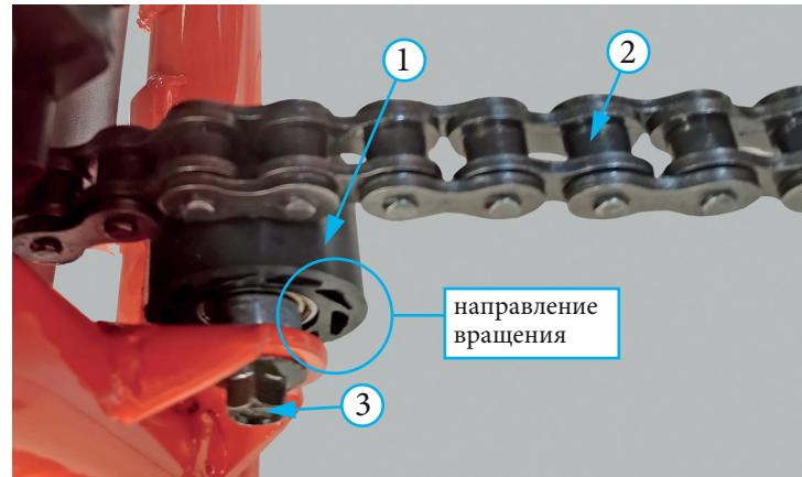
Фото 5.15. Ролик натяжителя цепи: 1 - ролик; 2 - цепь;
