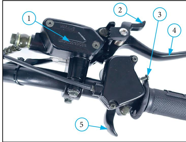
Фото 2.5. Переключатели правого рулевого блока комплекта запчасти: 1 - бачок переднего тормоза; 2 - фиксатор парковочного тормоза; 3 - регулятор ограничения акселератора; 4 - рычаг переднего тормоза; 5 - рычаг акселератора
