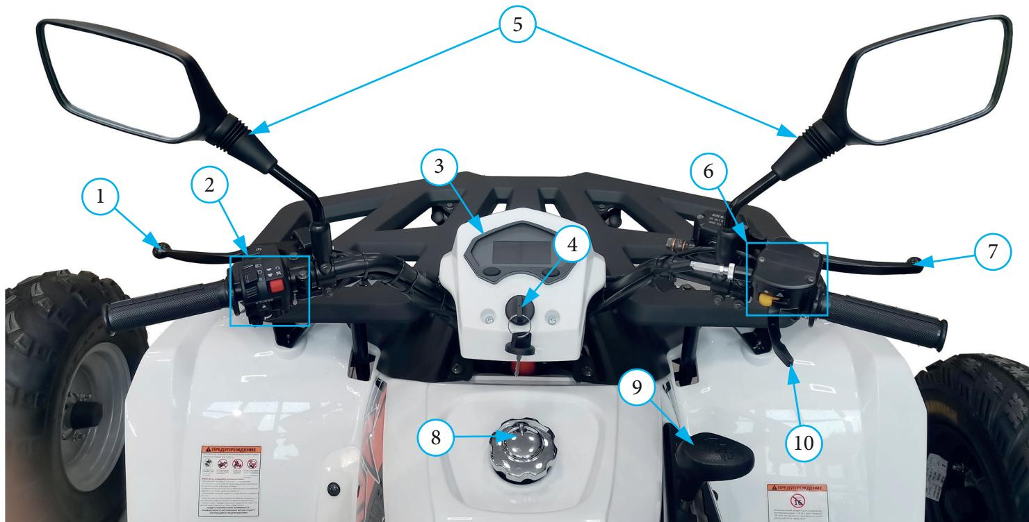
Фото 2.2.1 Приборы и органы управления квадрицикла: 1 – рычаг сцепления; 2 – левый рулевой блок; 3 – приборная панель; 4 – замок с ключом зажигания; 5 – зеркала заднего вида; 6 – правый рулевой блок; 7 – ручка переднего тормоза; 8 – крышка топливного бака; 9 – рычаг переключения передач; 10 – рычаг акселератора
