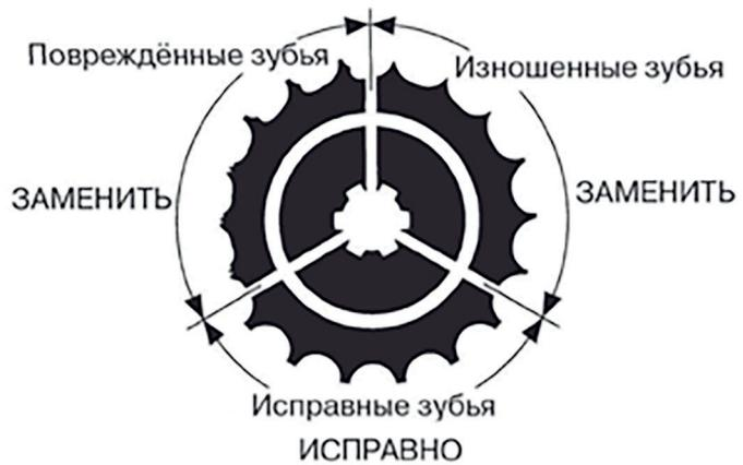
Рисунок 5.14. Вид зубьев звездочки
