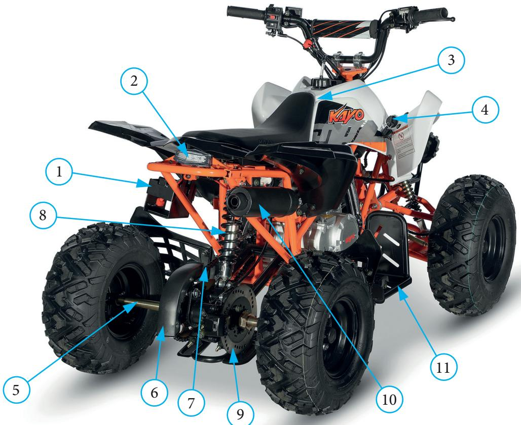
Фото 2.3. Вид с тыльной стороны комплекта запчастей: 1 - аккумуляторная батарея; 2 - задний фонарь; 3 - топливный бак;
