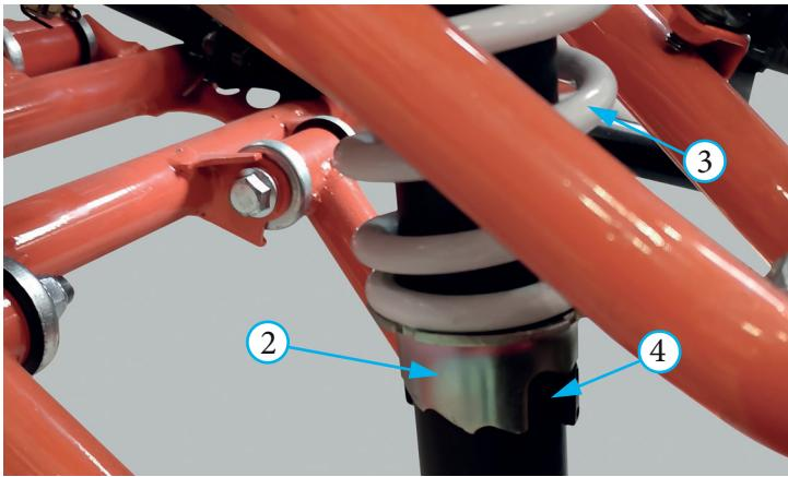
Фото 5.20. Преднатяг пружины переднего амортизатора
