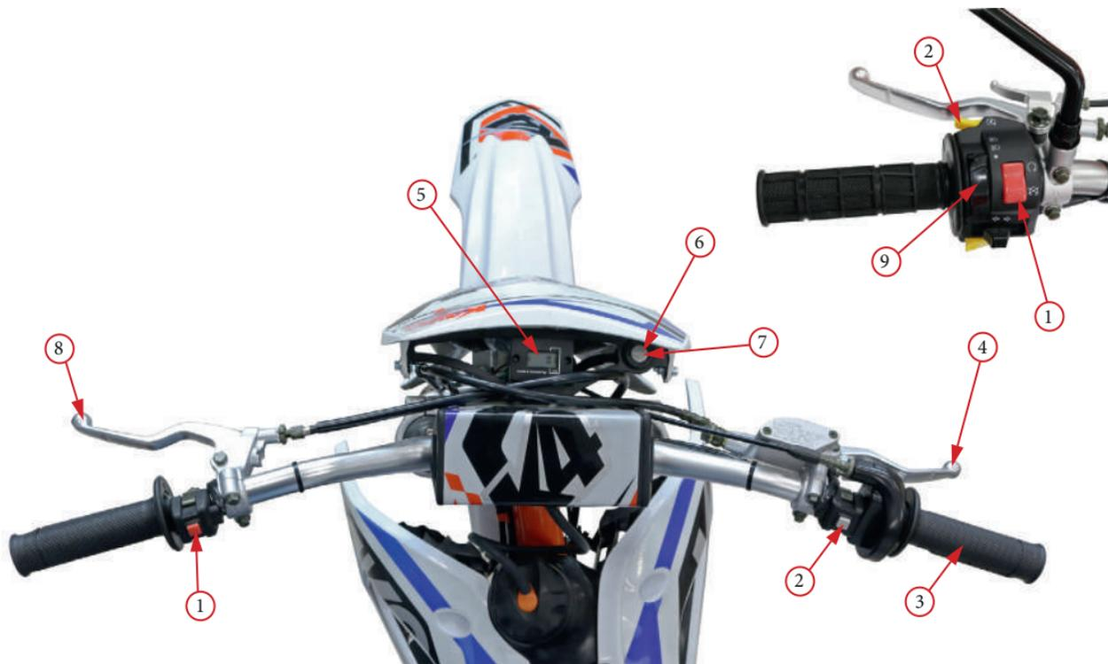
Фото 2.3. Приборы и органы управления: 1 – кнопка выключения двигателя; 2 – кнопка стартера; 3 – рукоятка акселератора; 4 – рычаг переднего тормоза; 5 – счетчик моточасов (приборная панель); 6 – замок зажигания; 7 – рычаг сцепления; 9 – переключатель фары (ближний/дальний свет).
