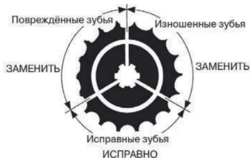
Рисунок 5.27. Вид зубьев звездочки.
