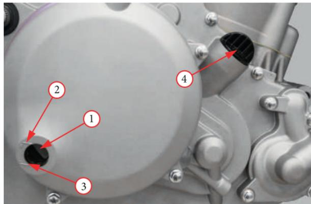
Фото 5.2 Варианты исполнения смотрового окна и крышки горловины двигателей: 1 - смотровое окно с указателями уровня (максимум - «2» и минимум - «3»); 4 – крышка маслосливной горловины.
