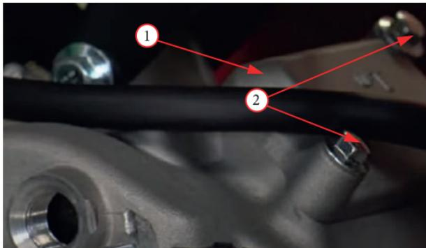
Фото 5.35. Снятие крышек клапанов: 1 – крышка впускного клапана;
