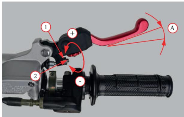
Фото 5.17. Регулировка передних тормозов.
