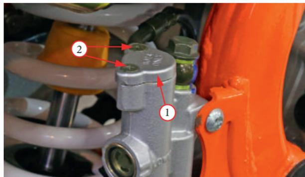
Фото 5.20. Долив тормозной жидкости.
