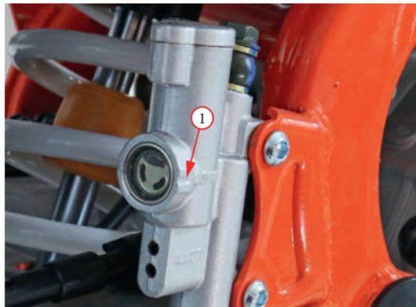
Фото 5.19. Проверка уровня тормозной жидкости.
