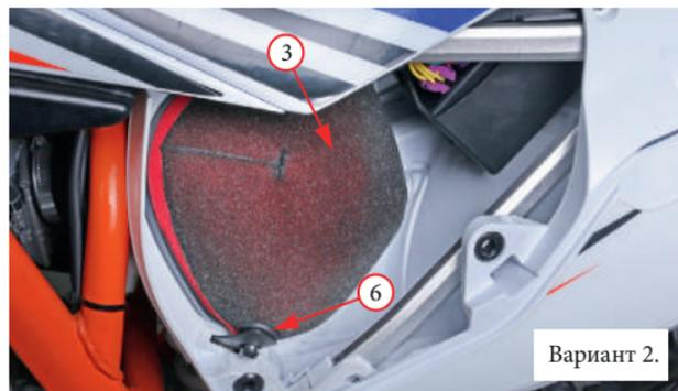
Фото 5.7. Варианты исполнения воздушных фильтров.
