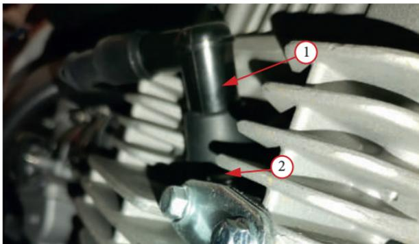
Фото 3.3. Свеча зажигания 1 с колпачком 2.
