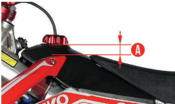
Фото 5.1. Уровень заправки «А» топливного бака.
