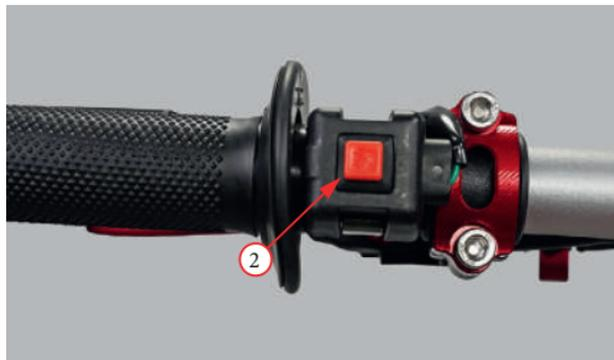
Фото 3.5.2. Кнопка остановки двигателя - 2.
