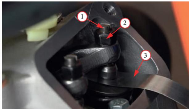
Фото 5.40. Регулировка теплового зазора: 1 – регулировочный винт;
