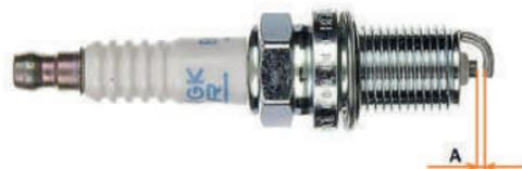
Фото 5.16. Зазор между электродами свечи зажигания.
