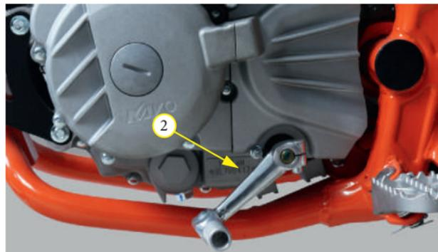
Фото 1.4. Место расположения серийного номера двигателя - 2.
