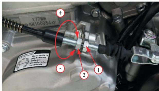
Фото 5.13. Регулировка сцепления на двигателе.
