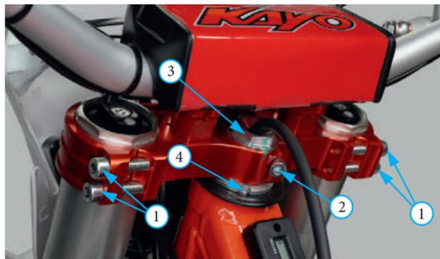
Фото 5.34. Регулировка подшипников рулевой колонки модели Kayo K6.
