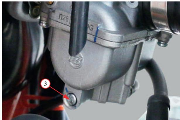
Фото 5.10. Регулировка холостых оборотов.
