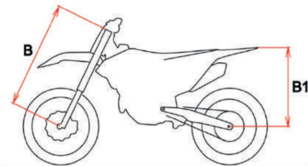
Рисунок 5.34. Замеры в разгрузке.
