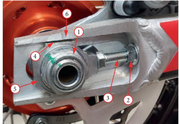
Фото 5.29. Регулировка натяжения цепи.
