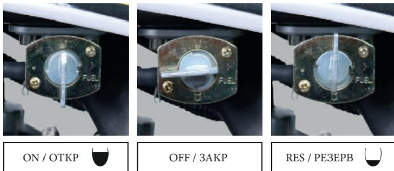
Фото 3.1. Положения крана подачи топлива.
