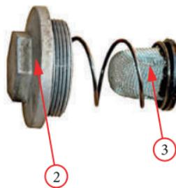
Фото 5.5. Замена масла в двигателях YX166FMM, ZS169FMM и ZS172FMM.
