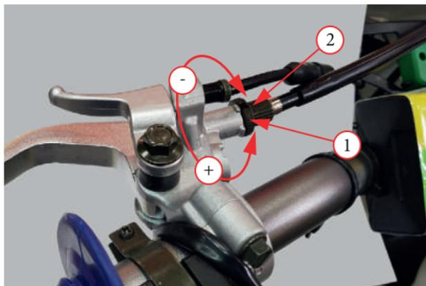
Фото 5.12. Регулировка свободного хода рычага сцепления.
