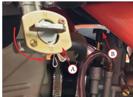
Фото 3.2. Топливный кран – А; рычаг обогапителя топливной смеси – В.
