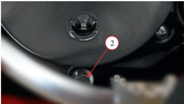
Фото 5.3.1. Сливной болт в двигателе LX1E66MM (MT-250 2T).
