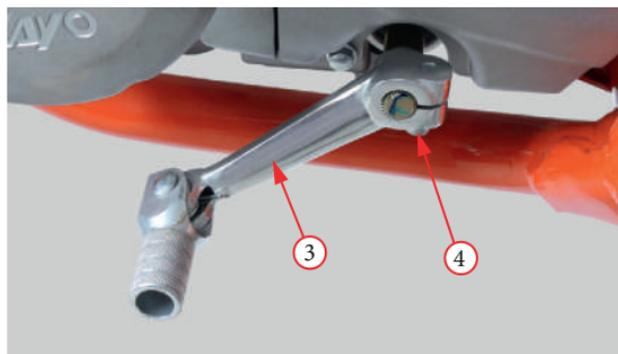
Фото 5.14. Регулировка положения рычага передач.
