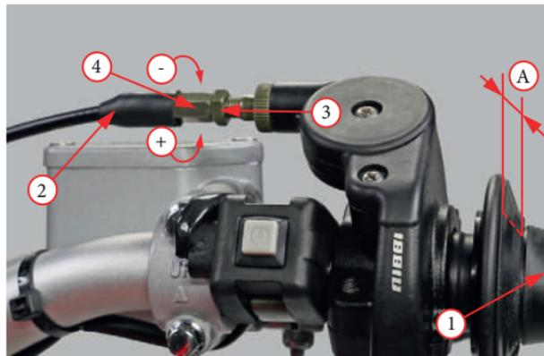
Фото 5.9. Регулировка свободного хода рукоятки акселератора.
