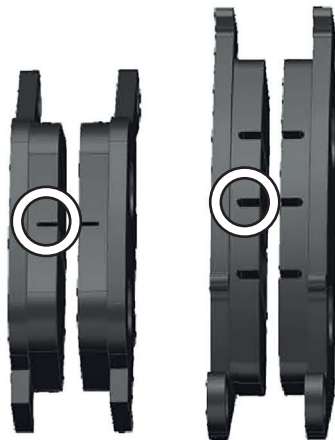
Фото 5.10. Определение износа тормозных колодок
