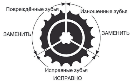
Рисунок 2. Износ звезд
