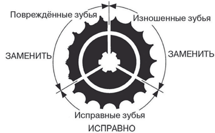
Рисунок 2. Износ звезд
