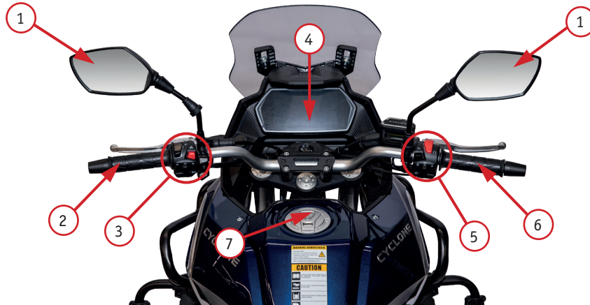
Фото 2.1. Вид руля и органов управления мотоцикла: 1 – зеркало заднего вида; 2 – левая рулевая рукоятка; 3 – левый комбинированный переключатель; 4 – приборная панель; 5 – правый комбинированный переключатель; 6 – рукоятка газа (акселератор); 7 – крышка топливного бака
