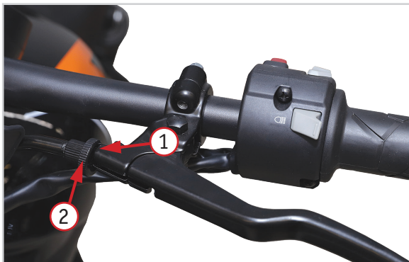
Фото 2.11. Регулировка сцепления: 1 – стопорная гайка; 2 – регулировочный винт
