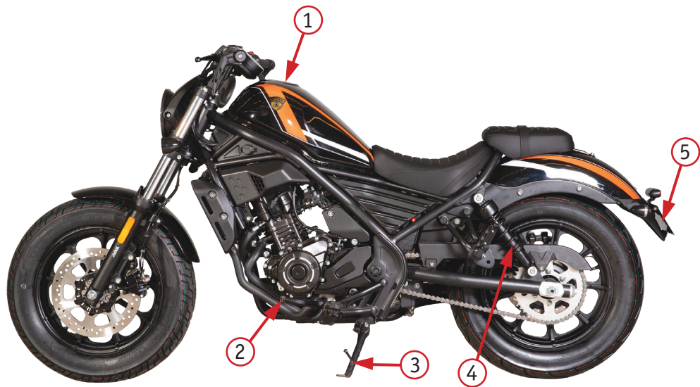
Фото 2.3. Вид слева: 1 – топливный бак; 2 – рычаг переключения передач; 3 – боковая подножка мотоцикла; 4 – задний амортизатор; 5 – крепление номерного знака
