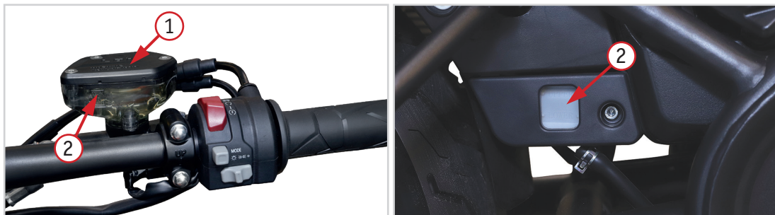
Фото 5.8 Уровень тормозной жидкости переднего и заднего тормозов: 1 – крышка; 2 – отметки минимум и максимум
