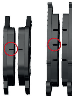
Фото 5.10. Определение износа тормозных колодок
