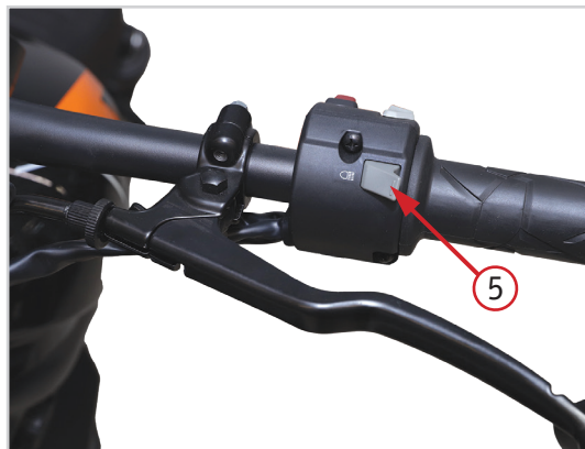
Фото 2.4 Левый комбинированный переключатель: 1 – переключатель режима света фары (дальний свет/ ближний свет); 2 – клавиша указателей поворота; 3 – кнопка звукового сигнала; 4 – кнопка аварийной сигнализации; 5 – кнопка включения дальнего света при обгоне
