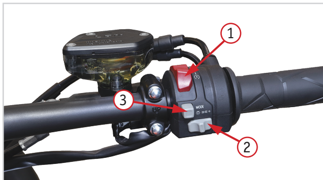
Фото 2.5. Правый комбинированный переключатель: 1 – кнопка электростартера; 2 – переключатель освещения; 3 – кнопка «MODE»
