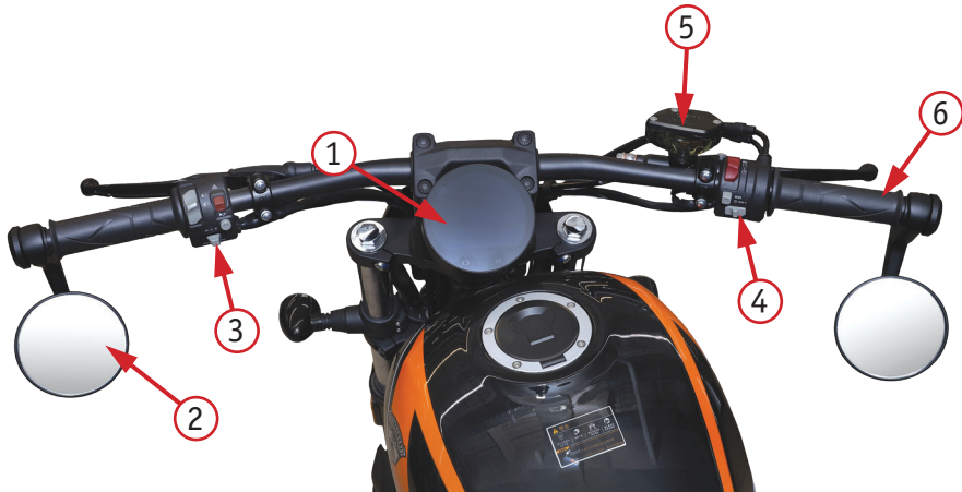
Фото 2.1. Вид руля и органов управления мотоцикла: 1 – приборная панель; 2 – зеркало заднего вида; 3 – левый комбинированный переключатель; 4 – правый комбинированный переключатель; 5 – бачок для тормозной жидкости; 6 – рукоятка газа (акселератор)
