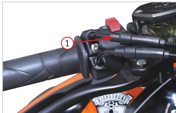
Фото 3. Регулировка троса газа: 1 – защитный колпачок
