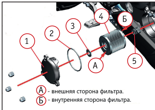
Фото 4.7. Замена масляного фильтра: 1 – крышка; 2 – уплотнительное кольцо; 3– шайба; 4– фильтр; 5– пружина.
