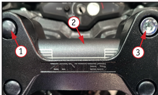
Фото 2.14. Крепление руля: 1 – пластиковые заглушки (4 штуки); 2 – руль; 3 – крепежные болты (4 штуки).
