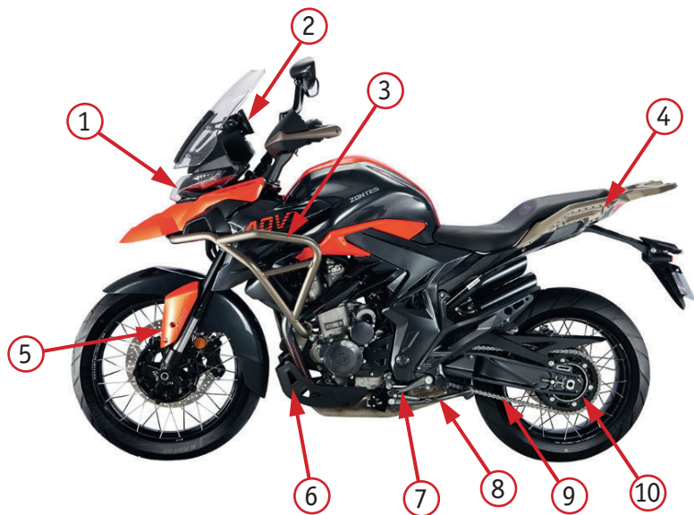
Фото 2.3. Вид слева: 1 – передняя фара; 2 – приборная панель; 3 – элементы защиты; 4 – заднее крыло; 5 – защита левого пера; 6 – защита картера; 7 – рычаг переключения передач; 8 – боковая подножка; 9 – приводная цепь; 10 – ведомая звезда.
