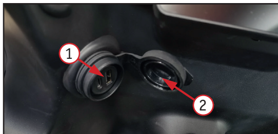
Фото 2.28. Разъем USB: 1 – разъем; 2 – защитная крышка
