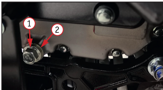
Фото 4.5. Слив моторного масла: сливной болт – 1; шайба - 2.
