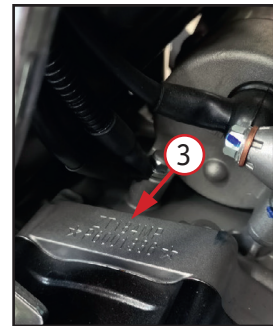
Фото 1.2. Справа на двигателе нанесен серийный номер двигателя – 3
