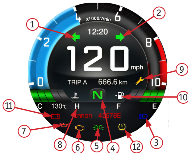
Фото 2.10. Вид приборной панели: 1 – индикатор левого поворотника; 2 – индикатор правого поворотника; 3 – индикатор дальнего света; 4 – индикатор нейтральной передачи; 5 – индикатор габаритных огней; 6 – индикатор неисправности EFI; 7 – индикатор пониженного давления масла; 8 – температура двигателя; 9 – индикатор технического обслуживания; 10 – количество топлива; 11 – индикатор пониженного напряжения батареи; 12 – индикатор пониженного давления в шинах
