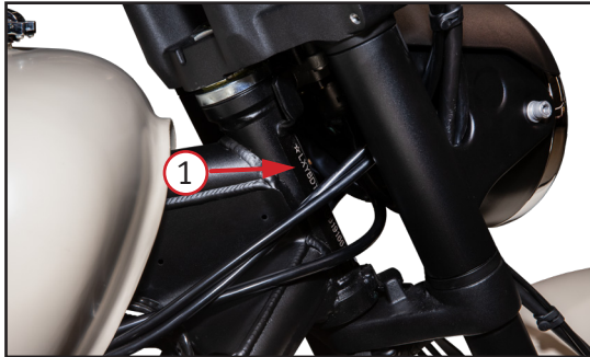
Фото 1.1. Идентификационный код транспортного средства (VIN) 1 расположен на правой стороне передней части мотоцикла
