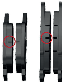
Фото 5.10. Определение износа тормозных колодок
