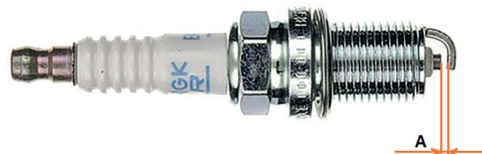
Фото 5.3. Зазор «А» между электродами свечи зажигания
