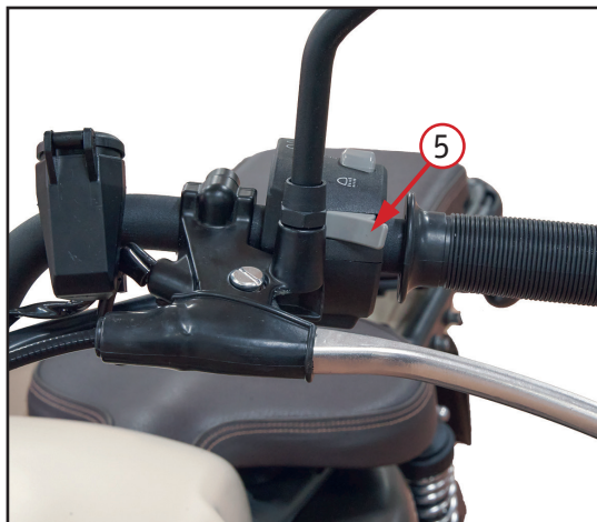
Фото 2.4.1 Левый комбинированный переключатель: 1 – клавиша управления панелью приборов; 2 – кнопка переключения режима света фары (дальний свет/ближний свет); 3 – переключатель указателей поворота; 4 – кнопка звукового сигнала; 5 – кнопка включения дальнего света при обгоне
