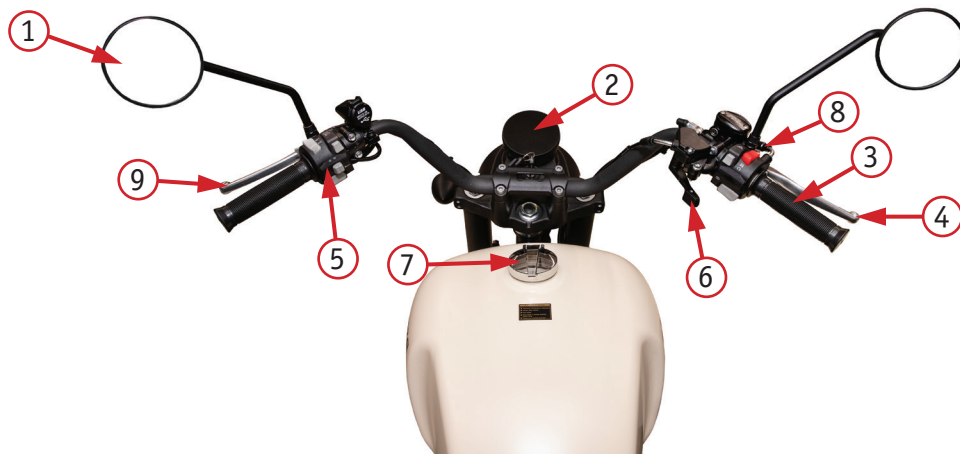
Фото 2.1. Вид руля и органов управления мотоцикла: 1 – зеркало заднего вида; 2 – приборная панель; 3 – ручка газа (акселератора); 4 – рычаг переднего тормоза; 5 – левый блок переключателей; 6 – рычаг включения задней передачи; 7 – крышка топливного бака; 8 – правый блок переключателей; 9 – рычаг сцепления
