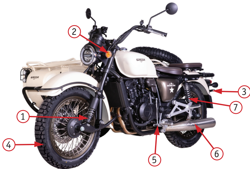
Фото 2.3. Вид слева: 1 – передний амортизатор; 2 – передний поворотный сигнал; 3 – крепление номерного знака; 4 – переднее колесо; 5 – лапка переключения передач; 6 – глушитель; 7 – задний амортизатор
