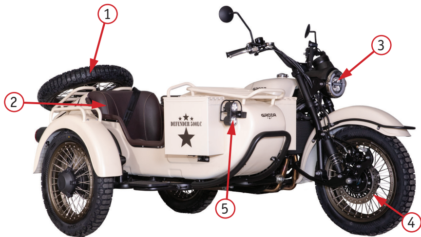
Фото 2.2. Вид справа: 1 – запасное колесо; 2 – сиденье коляски; 3 – фара; 4 – передний тормозной диск; 5 – передние габаритные огни
