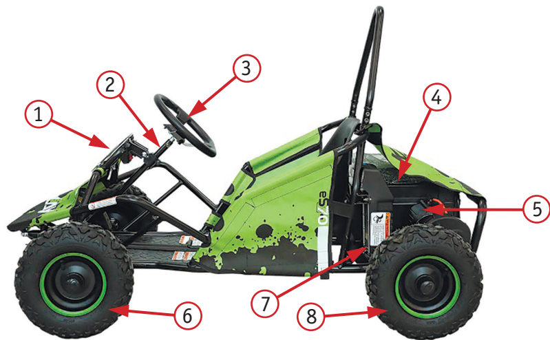
Фото 2.1.1. Левая сторона модели eS70: 1 – передний щиток; 2 – рулевой вал; 3 – руль; 4 – аккумуляторная батарея; 5 – электрический двигатель; 6 – передняя шина; 7 – контроллер; 8 – задняя шина
