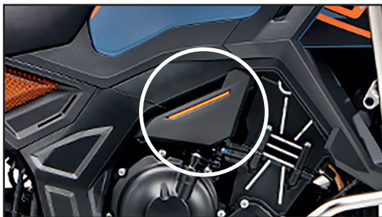
Фото 4.2 Место подключения зарядки АКБ: 1 – разъем зарядки
