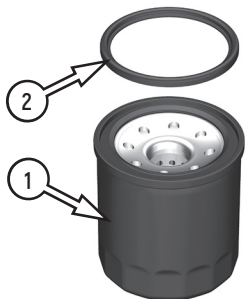
Фото 4.7. Масляный фильтр – 1; уплотнительное кольцо – 2
