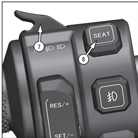
Фото 2.4. Левый блок переключателей: 1 – Переключатель круиз контроля +/SET; 2 – кнопка включения противотуманных фар; 3 – кнопка аварийной сигнализации; 4 – переключатель указателей поворота; 5 – кнопка звукового сигнала; 6 – кнопка ОК (джостик с пятью позициями); 7 - кнопка переключения режимов света фары (дальний/ближний); 8 – кнопка открывания сиденья
