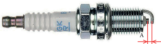
Фото 5.14. Зазор свечи зажигания – А
