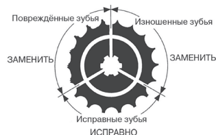
Рисунок 2. Износ звезд
