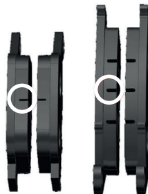
Фото 4.10. Контрольные канавки тормозных колодок
