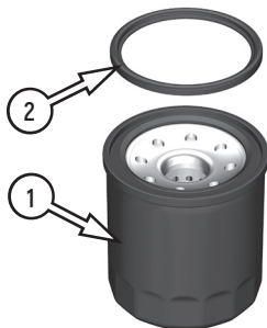
Фото 4.7. Масляный фильтр – 1; уплотнительное кольцо – 2
