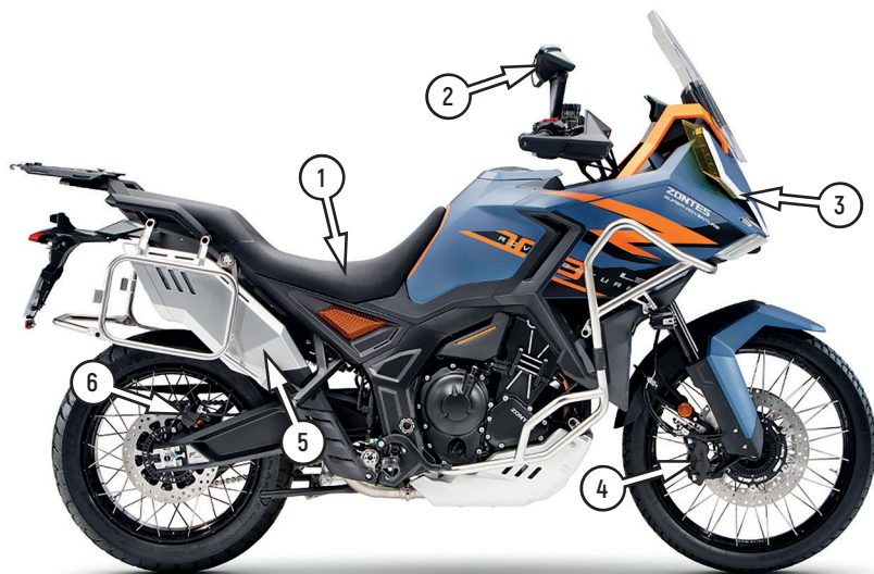
Фото 2.2. Вид справа: 1 – сиденье; 2 – зеркало заднего вида; 3 – передняя фара; 4 – передний тормозной суппорт; 5 – глушитель; 6 – задний тормозной суппорт
