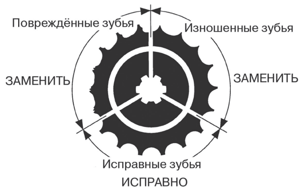
Рисунок 5.23. Вид зубьев звездочки
