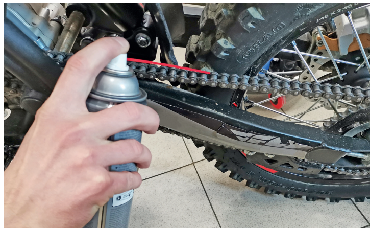
Фото 5.26. Очистка и смазка цепи
