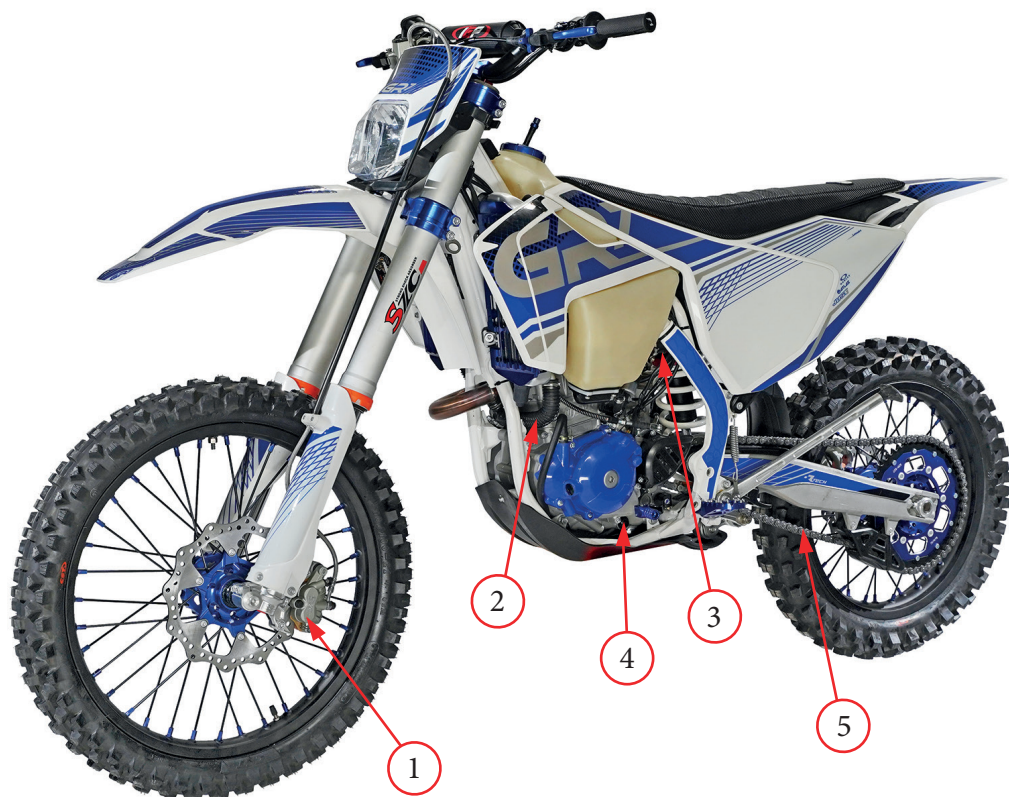
Фото 4.2.1. Узлы и механизмы с левой стороны (мотоцикл с инжектором): 1 - суппорт переднего тормоза; 2 - пагубки радиатора; 3 - воздушный фильтр; 4 - место размещения болта слива масла; 5 - приводная цепь
