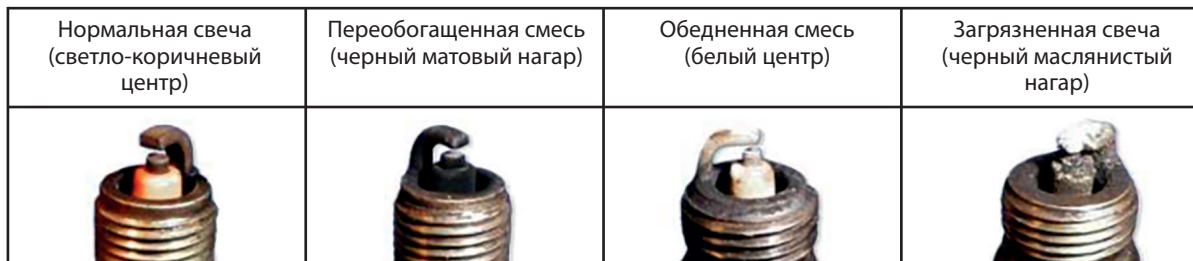
Фото 5.13. Состояния свечи зажигания
