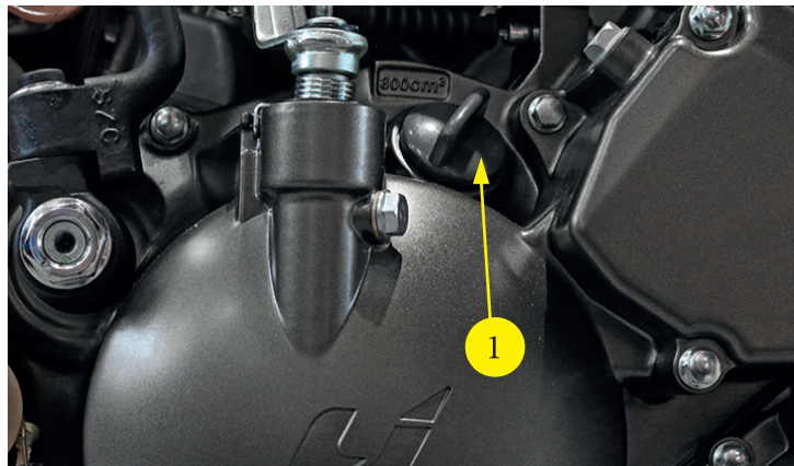
Фото 5.5. Замена масла в двигателе LX1E66MM (MT-250 2T)
