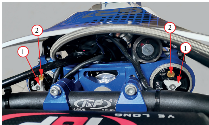
Фото 5.32. Регулировка сжатия (COM) передней вилки
