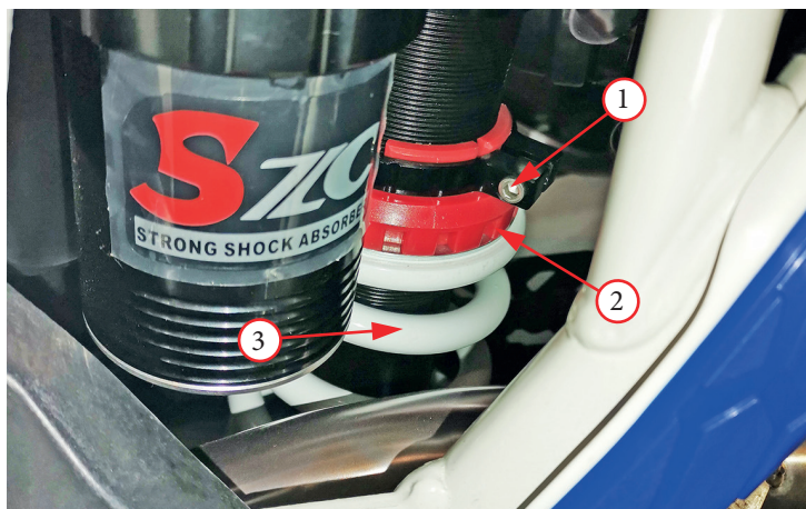
Фото 5.29. Регулировка преднатяга пружины заднего амортизатора
