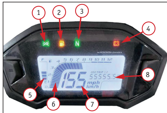
Фото 2.6. Приборная панель: 1 – индикатор габаритных огней; 2 – индикатор низкого уровня бензина в баке; 3 – индикатор нейтральной передачи; 4 – индикатор низкого заряда аккумуляторной батареи; 5 – показатель уровня топлива; 6 – указатель количества оборотов двигателя; 7 – указатель текущей скорости; 8 – указатель пройденного километража
