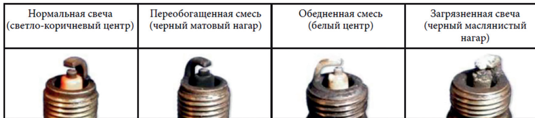
Фото 5.4. Состояния свечей зажигания
