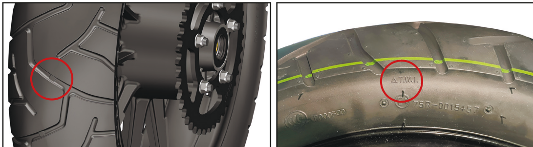
Фото 3.11. Расположение меток износа шины
