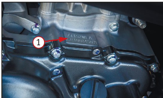
Фото 1.1. Справа на верхней части двигателя нанесен его серийный номер - 1
