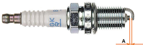
Фото 4.4. Зазор между электродами свечи зажигания
