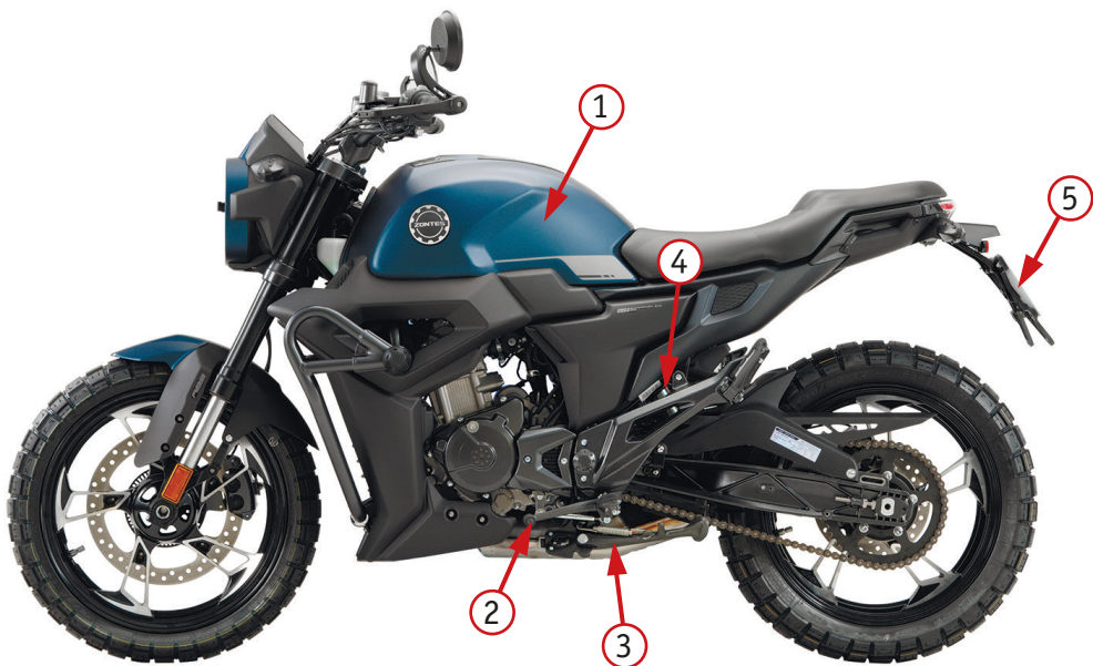
Фото 2.3. Вид слева: 1 – топливный бак; 2 – рычаг переключения передач; 3 – боковая подножка мотоцикла; 4 – задний амортизатор; 5 – крепление номерного знака
