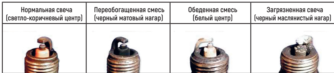
Фото 4.3. Состояния свечей зажигания
