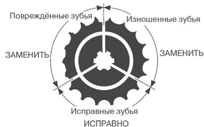
Рисунок 3. Износ звезд
