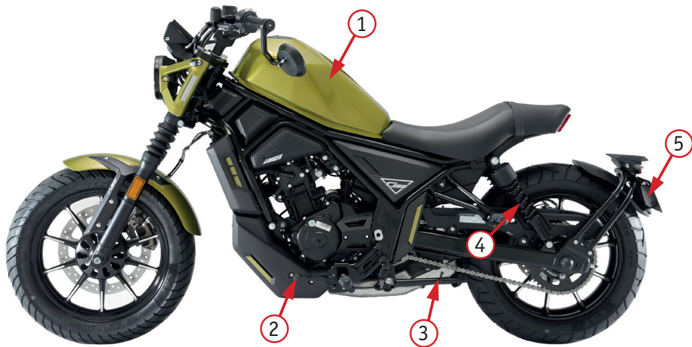
Фото 2.3. Вид слева: 1 – топливный бак; 2 – рычаг переключения передач; 3 – боковая подножка мотоцикла; 4 – задний амортизатор; 5 – крепление номерного знака
