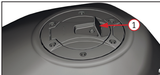
Фото 3.7. Топливный бак: 1 – защитная створка (язычок); 2 – крышка
