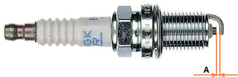
Фото 4.4. Зазор между электродами свечи зажигания
