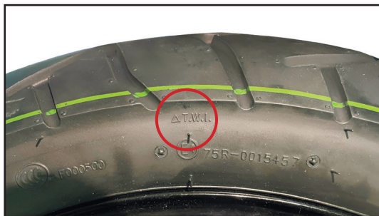
Фото 3.11. Расположение меток износа шины
