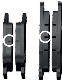
Фото 4.10. Контрольные канавки тормозных колодок
