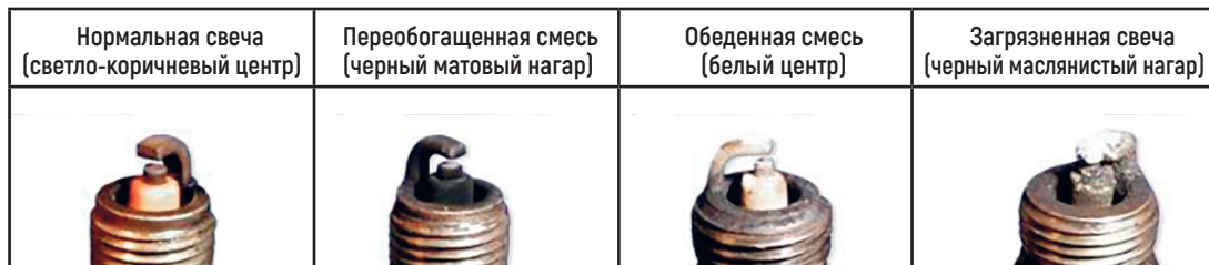
Фото 4.4. Состояния свечи зажигания
