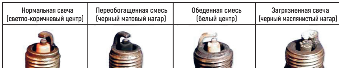
Фото 5.9. Состояния свечи зажигания
