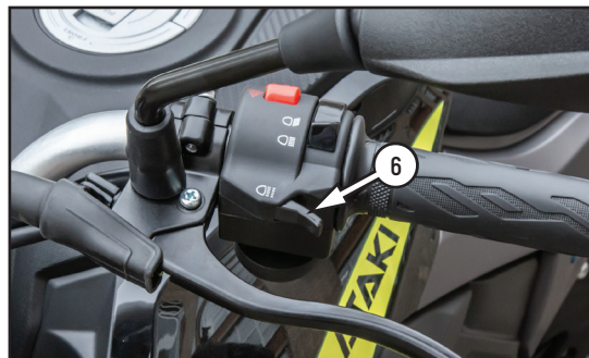
Фото 2.4.1 Левый комбинированный переключатель для моделей BATLLO, CARRERA 300, WEEK9, RA 300: 1 – переключатель режима света фары (дальний свет / ближний свет); 2 – клавиша указателей поворота; 3 – кнопка звукового сигнала; 4 – кнопка аварийной сигнализации; 5 – для модели BATLLO рычаг воздушной заслонки (обоганитель топливной смеси); 6 – кнопка включения дальнего света при обгоне
