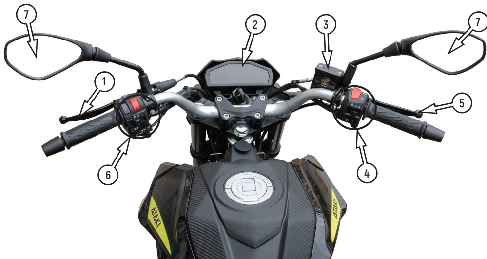
Фото 2.1. Вид руля и органов управления мотоцикла (пример): 1 – рычаг сцепления; 2 – приборная панель; 3 – бачок для тормозной жидкости; 4 – правый комбинированный переключатель; 5 – рычаг переднего тормоза; 6 – левый комбинированный переключатель; 7 – зеркало заднего вида
