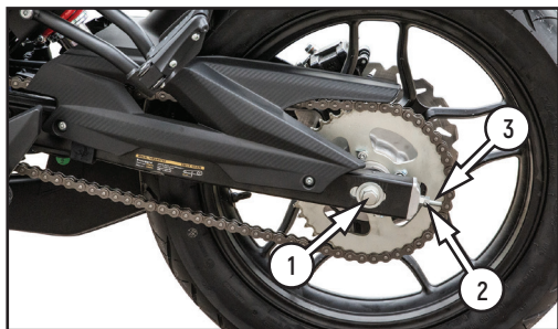
Фото 5.14. Регулировка натяжения цепи: 1 – гайка оси; 2 – регулировочный болт; 3 – стопорная гайка
