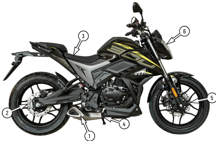
Фото 2.2. Вид справа (пример): 1 – глушитель; 2 – задний тормозной диск; 3 – сиденье; 4 – педаль заднего тормоза; 5 – передний тормозной диск; 6 – фара
