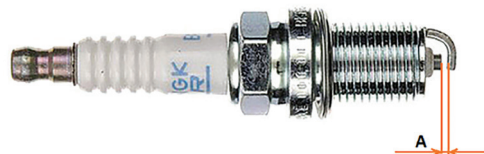
Фото 5.10. Зазор свечи зажигания «А»
