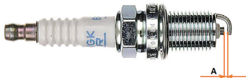
Фото 4.5. Зазор «А» между электродами свечи зажигания
