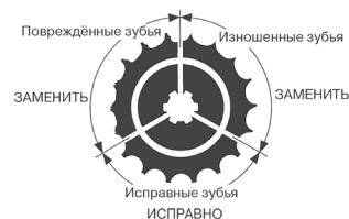
Рисунок 2. Износ звезд
