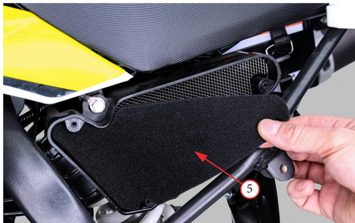
Фото 5.7. Обслуживание воздушного фильтра закрытого типа.
