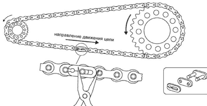
Рисунок 5.29. Установка элементов замка цепи.
