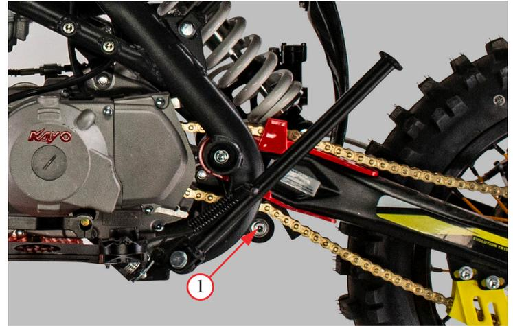
Фото 5.25. Ролик натяжения цепи – 1, слайдер-успокоитель – 2.
