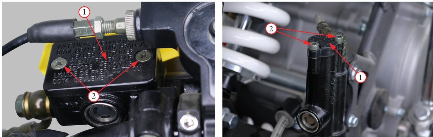
Фото 5.18. Долив тормозной жидкости.
