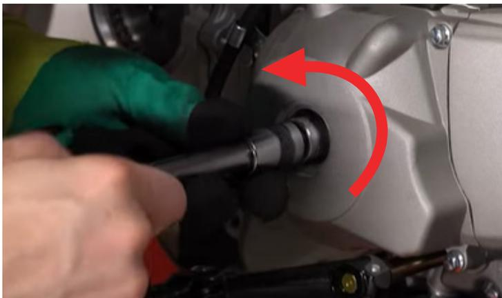
Фото 5.34. Направление вращения маховика коленчатого вала.
