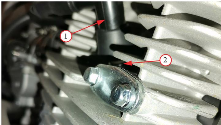
Фото 3.3. Колпачок – 1; свеча зажигания – 2.
