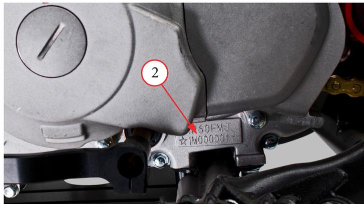
Фото 1.4. Место расположения серийного номера двигателя - 2.
