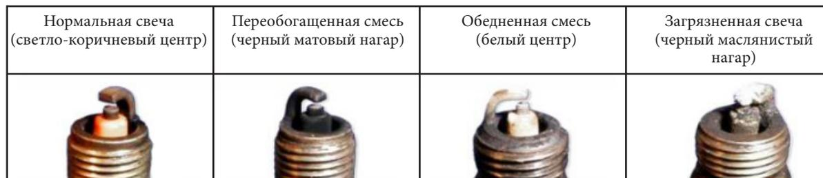
Фото 5.13. Состояния свечи зажигания.
