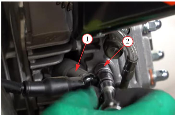
Фото 5.32. Снятие крышки звезды коленчатого вала.
