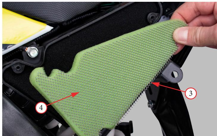
Фото 5.7. Обслуживание воздушного фильтра закрытого типа.
