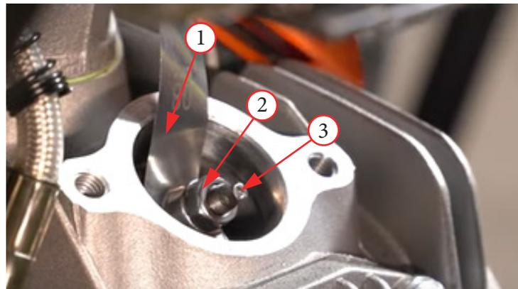
Фото 5.37. Регулировки теплового зазора:
