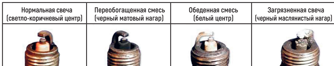
Фото 5.9. Состояния свечи зажигания
