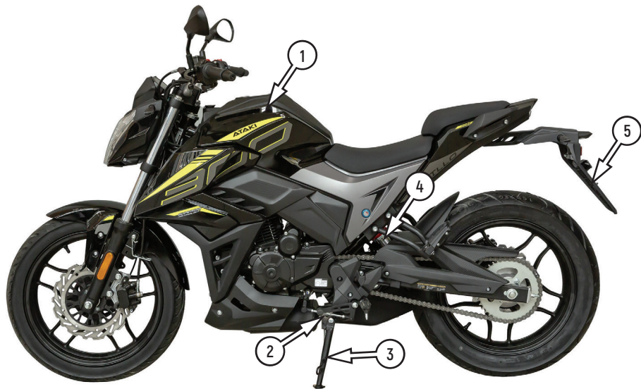
Фото 2.3. Вид слева (пример): 1 – топливный бак; 2 – рычаг переключения передач; 3 – боковая подножка мотоцикла; 4 – задний амортизатор; 5 – крепление номерного знака
