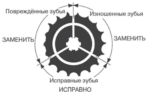
Рисунок 2. Вид зубьев звездочки
