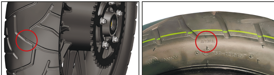
Фото 3.11. Расположение меток износа шины
