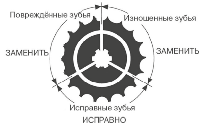
Рисунок 3. Износ звезд
