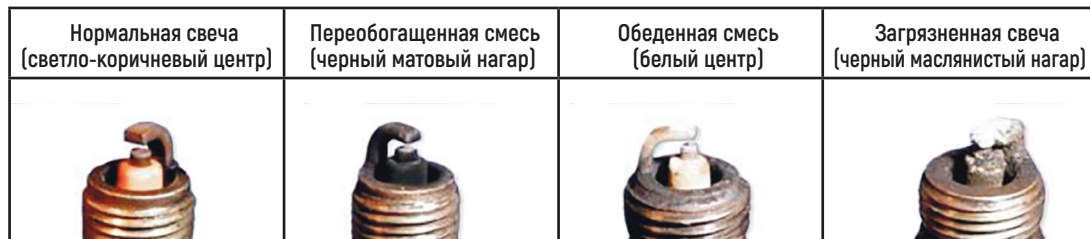
Фото 4.3. Состояния свечей зажигания
