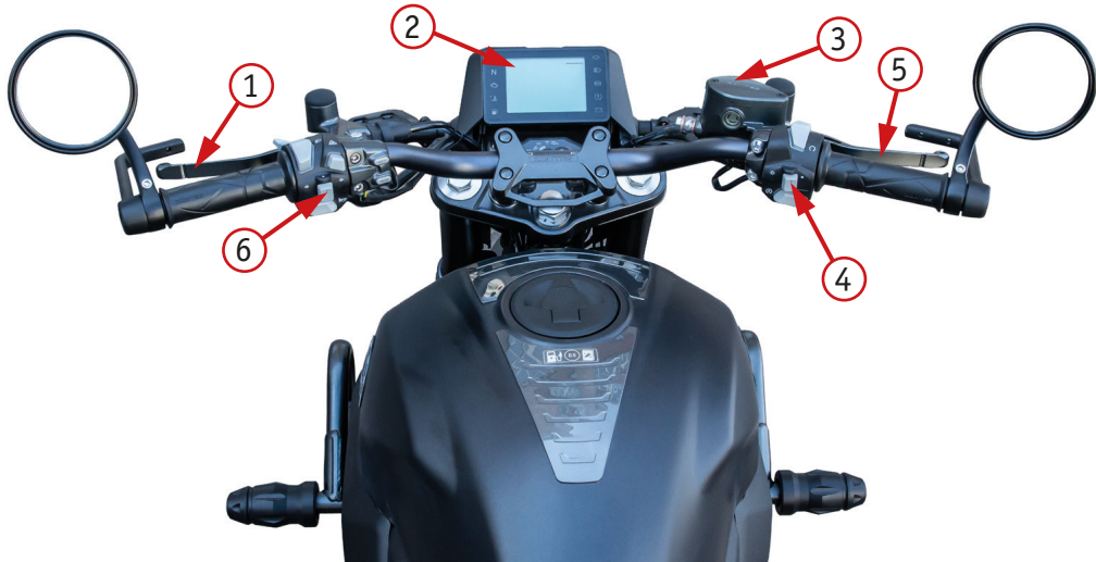
Фото 2.1. Вид руля и органов управления мотоцикла: 1 – рычаг сцепления; 2 – приборная панель; 3 – бачок для тормозной жидкости; 4 – правый комбинированный переключатель; 5 – рычаг переднего тормоза; 6 – левый комбинированный переключатель
