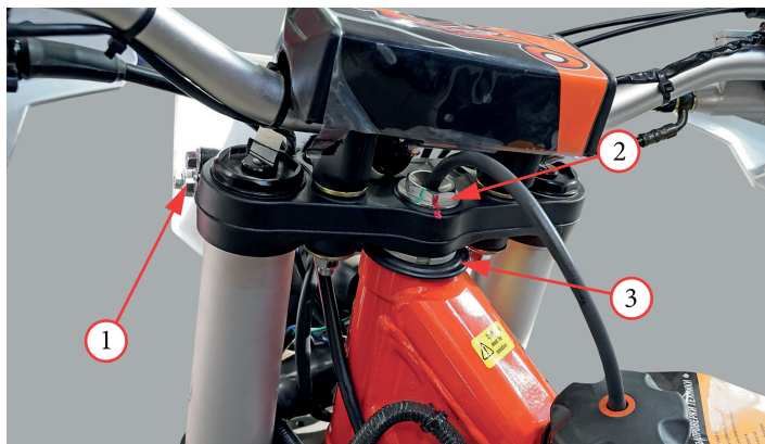
Фото 5.33. Регулировка подшипников рулевой колонки
