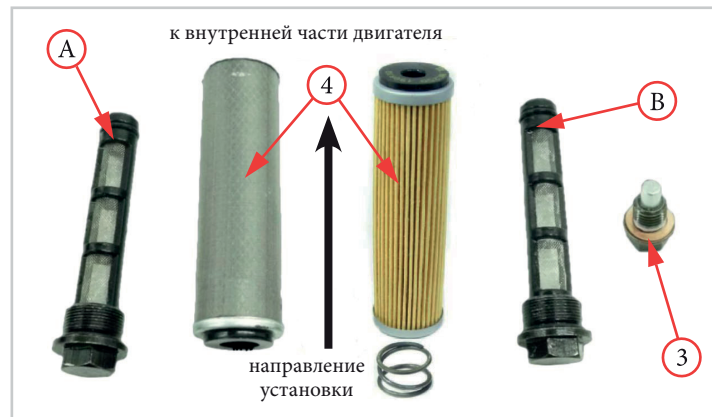
Фото 5.4.1. Замена масла в двигателях с масляным фильтром
