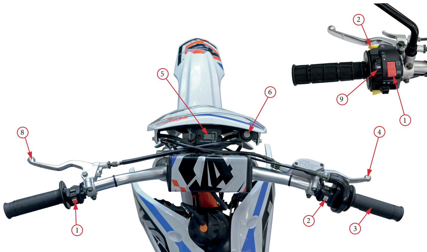
Фото 2.3. Приборы и органы управления: 1 – кнопка выключения двигателя; 2 – кнопка стартера; 3 – рукоятка акселератора; 4 – рычаг переднего тормоза; 5 – счетчик моточасов (приборная панель); 6 – замок зажигания; 8 – рычаг сцепления; 9 – переключатель фары (ближний/дальний свет)
