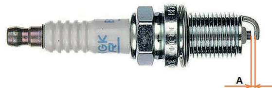
Фото 5.16. Зазор между электродами свечи зажигания
