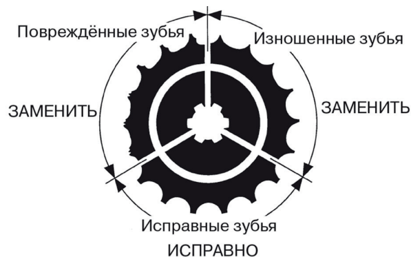
Рисунок 5.27. Вид зубьев звездочки
