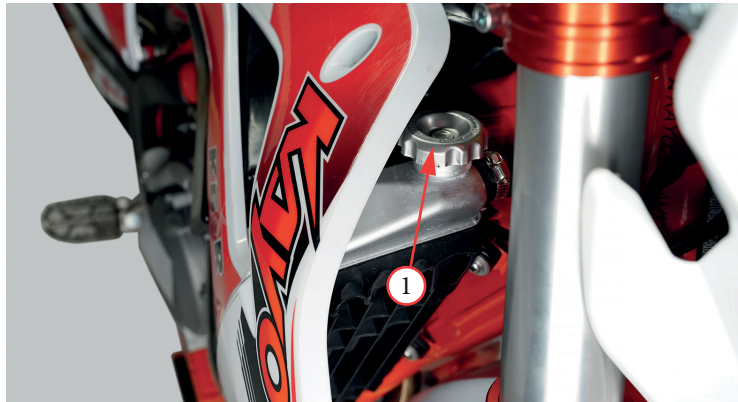
Фото 5.6. Контроль уровня охлаждающей жидкости
