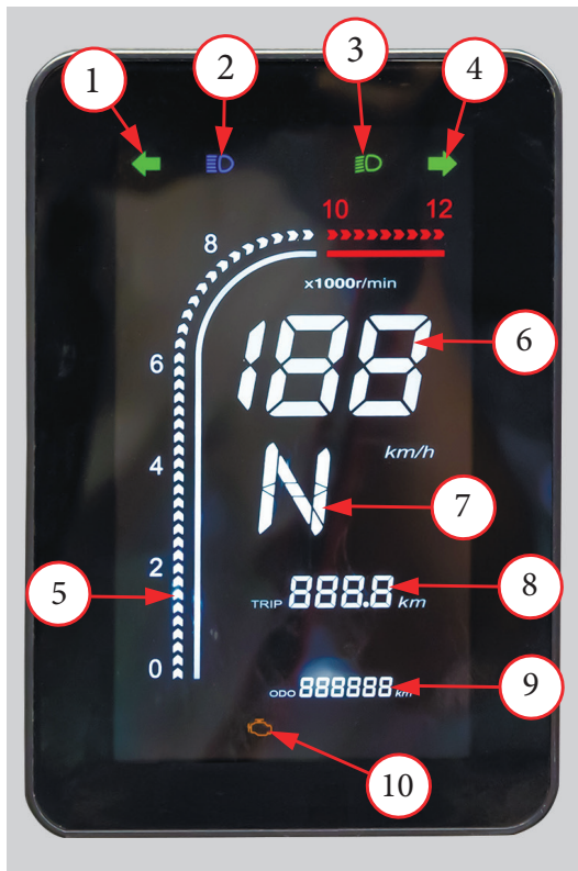
Фото 2.6 Приборная панель на примере мотоцикла GR S3 RALLY: 1 – указатель левого поворота; 2 – указатель дальнего света фары; 3 – указатель ближнего света фары; 4 – указатель правого поворота; 5 – шкала указателя оборотов двигателя; 6 – указатель скорости движения; 7 – указатель нейтральной передачи; 8 – указатель пройденного пути в текущее время; 9 – указатель общего километража пути; 10 – указатель неисправности двигателя
