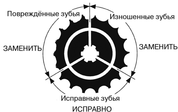
Рисунок 5.23. Вид зубьев звездочки
