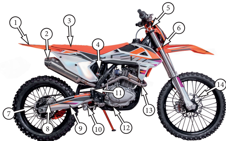
Фото 2.2. Правая сторона мотоцикла (вариант): 1 – заднее крыло; 2 – глушитель; 3 – сиденье; 4 – задний амортизатор; 5 – верхний зажим; 6 – нижний зажим; 7 – диск заднего тормоза; 8 – задний тормозной суппорт; 9 – маятник; 10 – треугольное коромысло; 11 – задний тормозной цилиндр; 12 – педаль заднего тормоза; 13 – выхлопная труба; 14 – диск переднего тормоза
