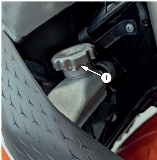
Фото 5.6. Контроль уровня охлаждающей жидкости: 1 – крышка радиатора; 2 – бачек; 3 – уровень «максимум»; 4 – уровень «минимум»
