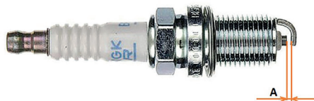
Фото 5.13. Зазор между электродами свечи зажигания
