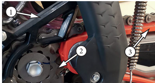
Фото 5.20. Передняя защита цепи - 1; ведущая звезда - 2; слайдер - успокоитель - 3
