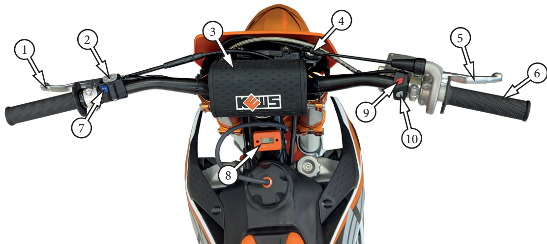
Фото 2.3. Приборы и органы управления (вариант): 1 – рычаг сцепления; 2 – переключатель ближнего/дальнего света; 3 – подушка на руль; 4 – замок зажигания; 5 – рычаг переднего тормоза; 6 – рукоятка акселератора (газа); 7 – кнопка включения дальнего света при обгоне; 8 – счетчик наработки; 9 – кнопка выключения двигателя; 10 – кнопка электростартера
