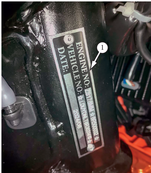
Фото 1.3. Место расположения бирки с указанием: модели и номера двигателя; номера VIN мотоцикла и даты выпуска
