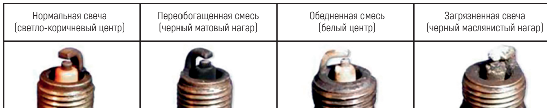
Фото 5.12. Состояния свечей зажигания
