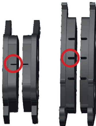
Фото 5.10. Определение износа тормозных колодок
