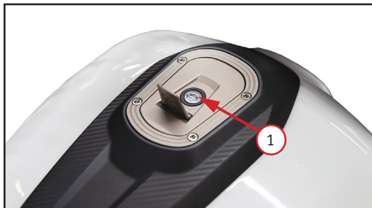
Фото 2.6. Топливный бак: 1 – замочная скважина на крышке; 2 – заливная горловина
