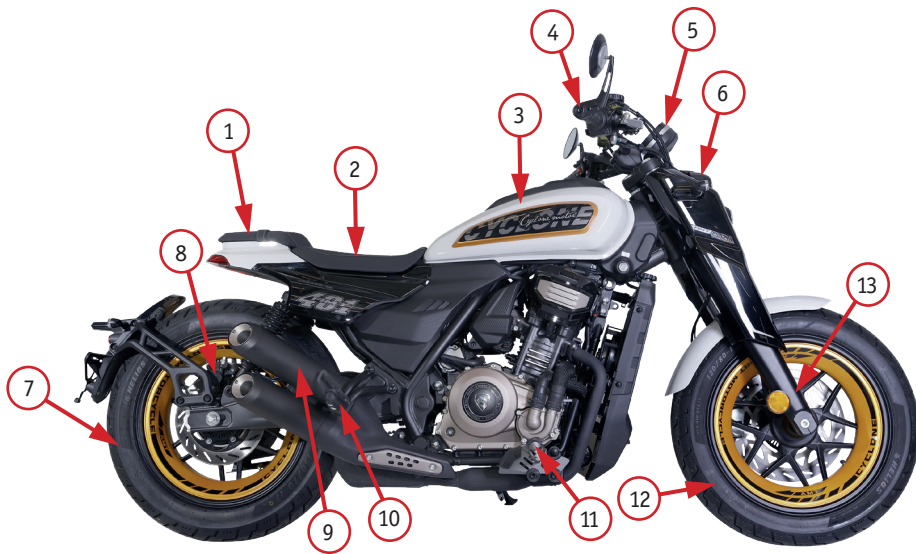
Фото 2.2. Вид мотоцикла: 1 – пассажирское сиденье; 2 – сиденье водителя; 3 – топливный бак; 4 – руль; 5 – приборная панель; 6 – фара; 7 – заднее колесо; 8 – задний тормозной суппорт; 9 – глушитель; 10 – подножка пассажира; 11 – подножка водителя; 12 – переднее колесо; 13 – передний амортизатор
