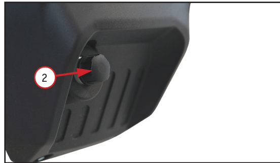
Фото 5.7. Замена охлаждающей жидкости: 1 – крышка радиатора; 2 – крышка бачка
