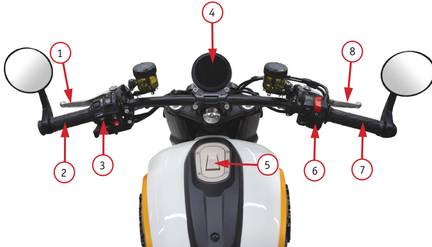
Фото 2.1. Вид руля и органов управления мотоцикла: 1 – ручка заднего тормоза; 2 – левая рулевая рукоятка; 3 – левый комбинированный переключатель; 4 – приборная панель; 5 – крышка топливного бака; 6 – правый комбинированный переключатель; 7 – рукоятка газа (акселератор); 8 – ручка переднего тормоза
