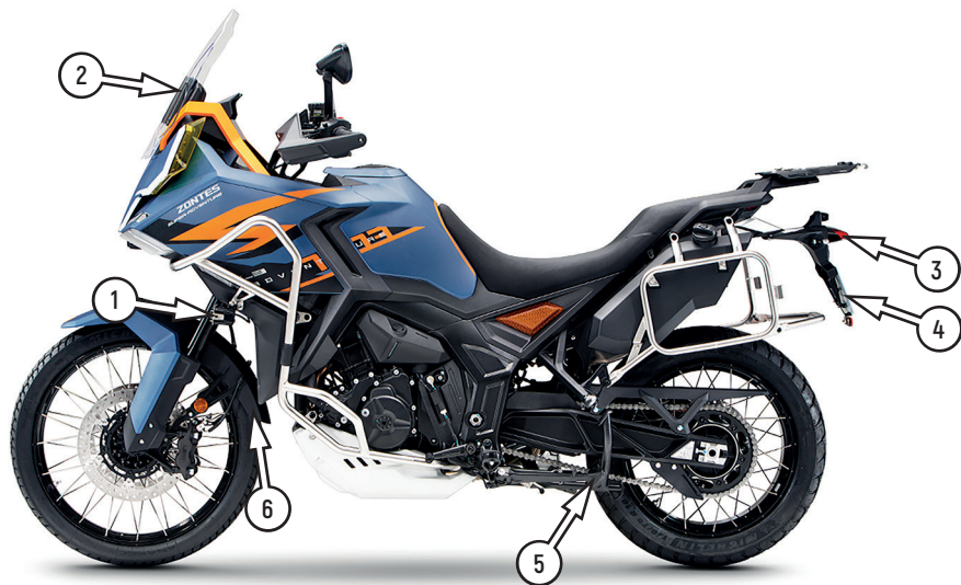
Фото 2.3 Вид слева: 1 – передние амортизаторы; 2 – ветровое стекло; 3 – задний фонарь; 4 – заднее крыло; 5 – центральная подставка; 6 – переднее крыло
