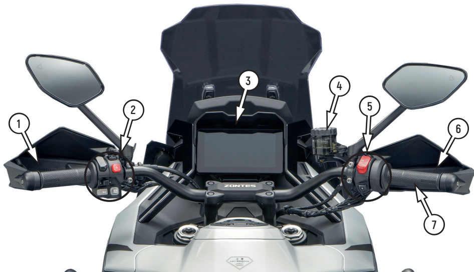
Фото 2.1. Вид руля и органов управления: 1 – рычаг сцепления; 2 – левый блок переключателей; 3 – приборная панель; 4 – бачок для тормозной жидкости передних тормозов; 5 – правый блок переключателей; 6 – ручка переднего тормоза; 7 – ручка газа (акселератора)
