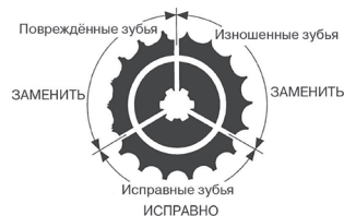
Рисунок 2. Износ звезд
