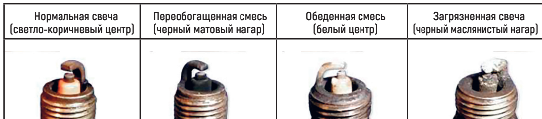
Фото 4.4. Состояния свечи зажигания
