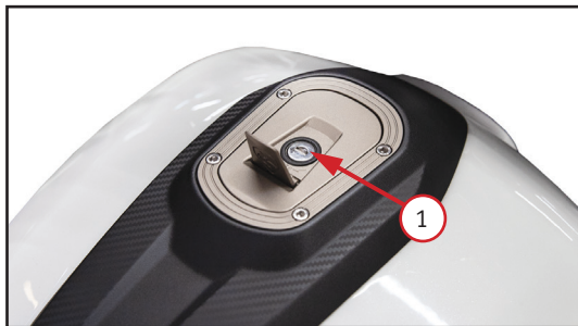
Фото 2.6. Топливный бак: 1 – замочная скважина на крышке; 2 – заливная горловина
