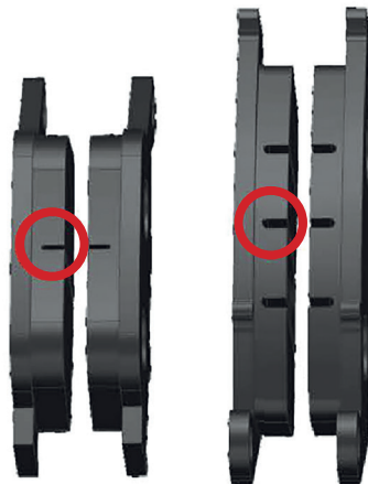
Фото 5.10. Определение износа тормозных колодок
