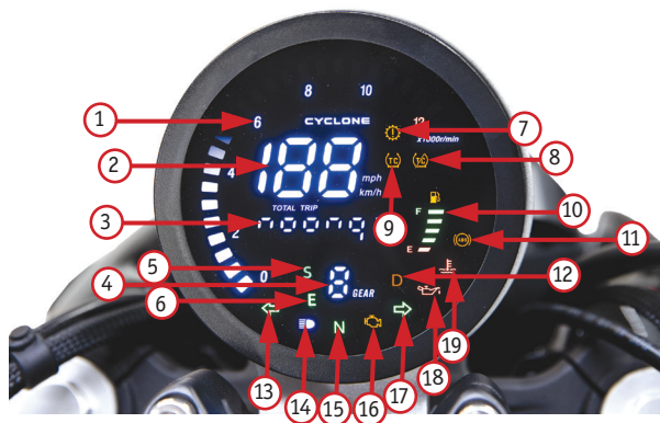
Фото 2.10. Вид приборной TFT-панели: 1 – тахометр; 2 – спидометр; 3 – одометр; 4 – индикатор передачи; 5 – индикатор спортивного режима; 6 – индикатор экономичного режима; 7 – индикатор неисправности трансмиссии; 8 – индикатор отключённой системы стабилизации (TCS OFF); 9 – индикатор включённой системы стабилизации (TCS ON); 10 – указатель уровня топлива; 11 – индикатор ABS; 12 – индикатор автоматического режима коробки передач; 13 – левый поворотник; 14 – дальний свет; 15 – нейтральная передача; 16 – индикатор неисправности системы EFI; 17 – правый поворотник; 18 – индикатор давления масла; 19 – индикатор перегрева охлаждающей жидкости.
