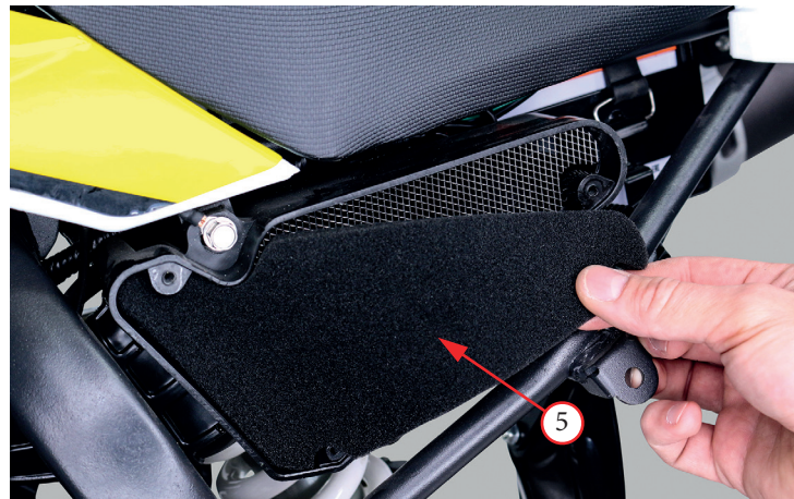
Фото 5.7. Обслуживание воздушного фильтра закрытого типа
