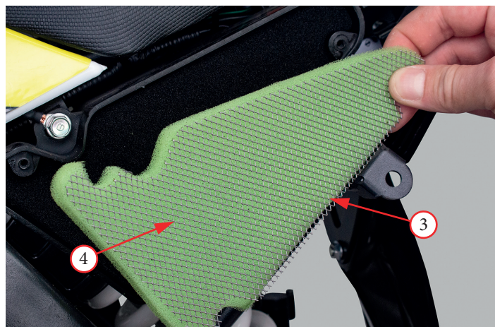
Фото 5.7. Обслуживание воздушного фильтра закрытого типа
