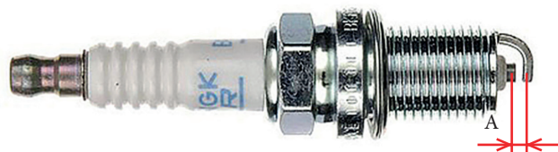
Фото 5.14. Зазор свечи зажигания – А
