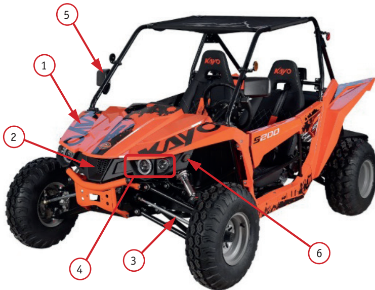
Фото 2.3. Передняя сторона квадрицикла: 1 – передний пластиковый обтекатель; 2 – решетка вентиляции; 3 – осветительные фары; 4 – рулевая тяга; 5 – зеркало заднего вида; 6 – передний указатель поворота
