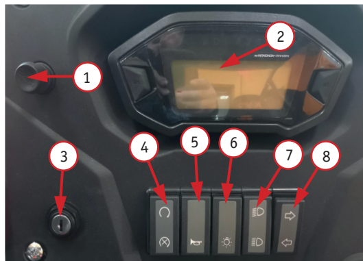
Фото 2.5. Органы щитка управления: 1 – рычаг обогащения топливной смеси; 2 – приборная панель; 3 – замок зажигания; 4 – включатель-выключатель электропитания; 5 – клавиша звукового сигнала; 6 – клавиша включения освещения; 7 – клавиша переключения дальнего/ближнего режима работы фары; 8 – клавиша включения указателей поворотов
