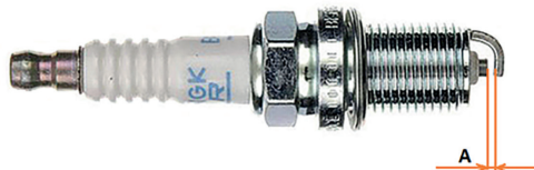
Фото 5.9. Зазор свечи зажигания - А
