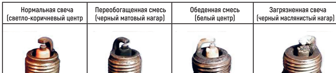
Фото 5.8. Состояния свечей зажигания
