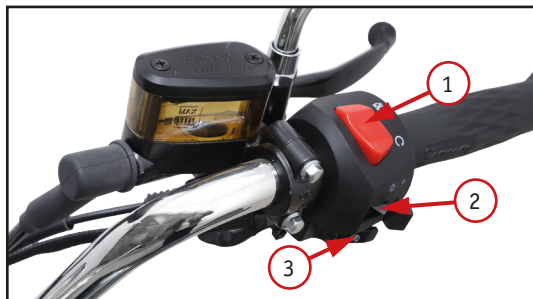
Фото 2.4. Правый комбинированный переключатель: 1 – кнопка включения/отключения питания; 2 – переключатель освещения; 3 – электростартер
