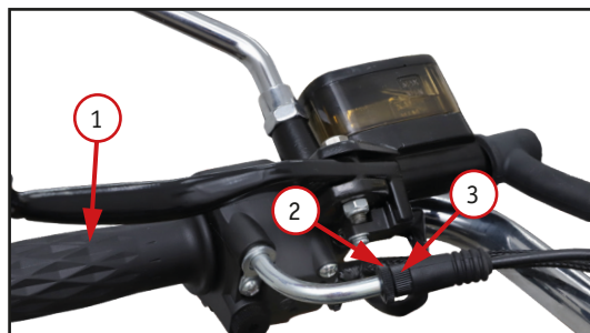
Фото 3. Регулировка троса газа: 1 – ручка газа (акселератора); 2 – стопорная гайка; 3 – регулировочная гайка
