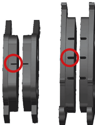
Фото 5.8. Определение износа тормозных колодок
