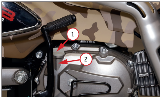
Фото 5.1. Контроль: 1 – щуп контроля уровня масла; 2 – заливная горловина
