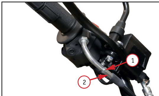
Фото 5.4. Регулировка троса газа: 1 – стопорная гайка; 2 – регулировочная гайка
