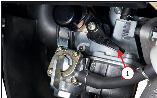
Фото 3.2. Рычаг воздушной заслонки (обогащения топливной смеси) – 1
