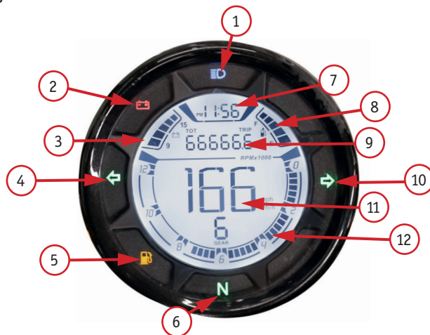
Фото 2.10. Вид приборной TFT-панели: 1 – индикатор дальнего света; 2 – сигнал низкого напряжения батареи; 3 – напряжение батареи; 4 – левый поворотник; 5 – сигнал низкого уровня топлива; 6 – индикатор нейтрали; 7 – часы; 8 – указатель уровня топлива; 9 – одометр; 10 – правый поворотник; 11 – спидометр; 12 – тахометр
