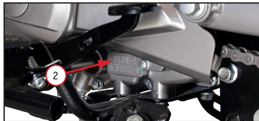
Фото 1.2. Слева на картере нанесен серийный номер двигателя 2
