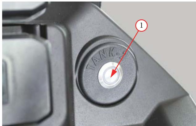
Фото 3.6. Кнопка переключения топливных баков – 1
