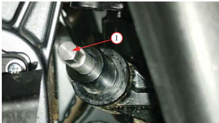
Фото 2.17. Регулировочный винт 1 преднатяга пружины заднего амортизатора
