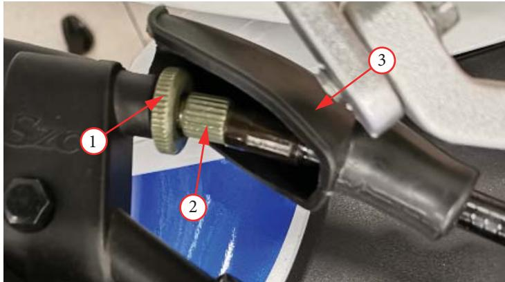
Фото 2.14. Регулировка свободного хода рычага сцепления:
