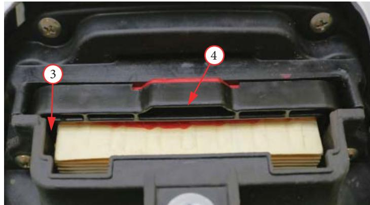
Фото 4.3. Снятие воздушного фильтра: 1 – крышка отсека; 2 – фиксаторы крышки; 3 – отсек для воздушного фильтра; 4 – ручка корпуса фильтра
