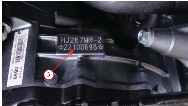
Фото 1.4. Место расположения серийного номера двигателя – 3
