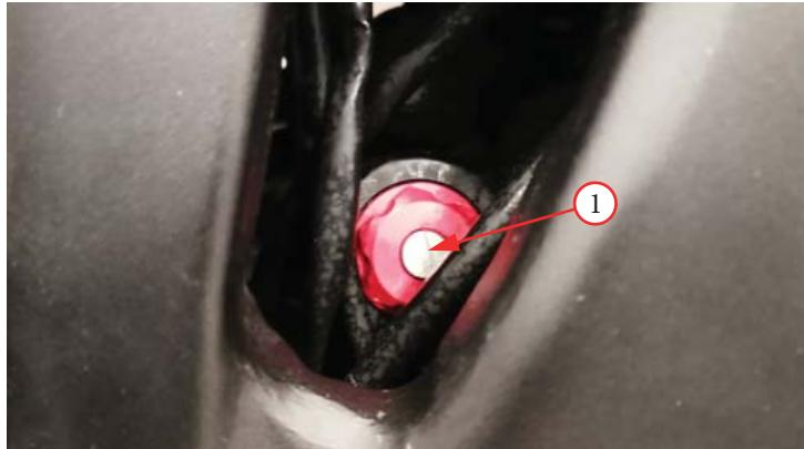
Фото 2.18. Регулировочный винт 1 сжатия пружины заднего амортизатора
