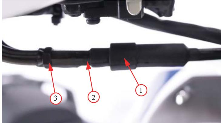
Фото 2.13. Регулировка троса газа: 1 – резиновый кожух;
