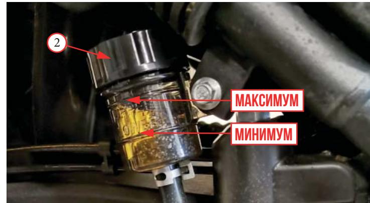
4.11.2. Бачок тормозной жидкости задних тормозов:
