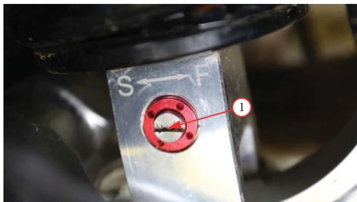
Фото 2.19. Винт регулировки отбоя – 1
