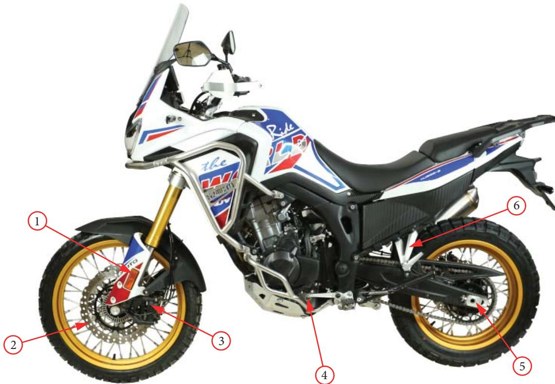
Фото 2.4. Вид слева: 1 – передний светоотражатель (левый); 2 – передний тормозной диск; 3 – передний тормозной суппорт; 4 – рычаг переключения передач; 5 – натяжитель цепи привода (левый); 6 – подножка пассажира (левая)
