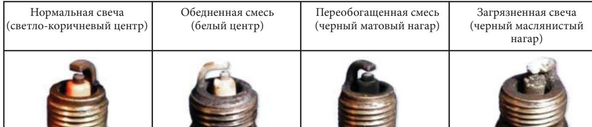
Фото 4.4. Состояния свечей зажигания
