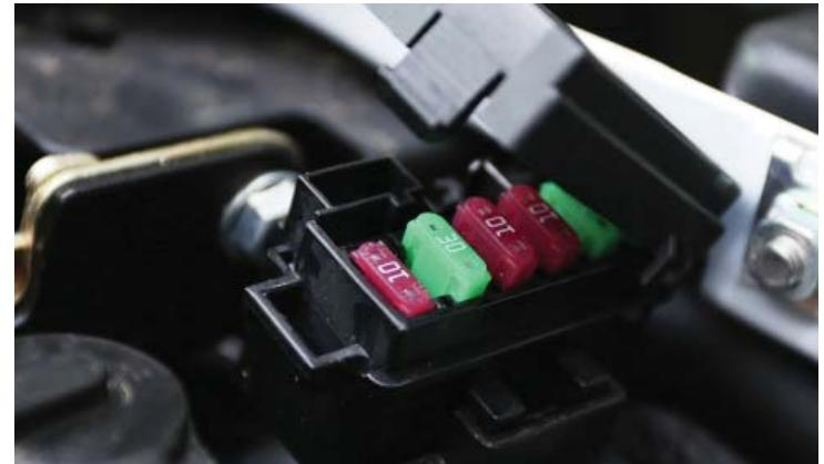
Фото 4.14. Блок с предохранителями
