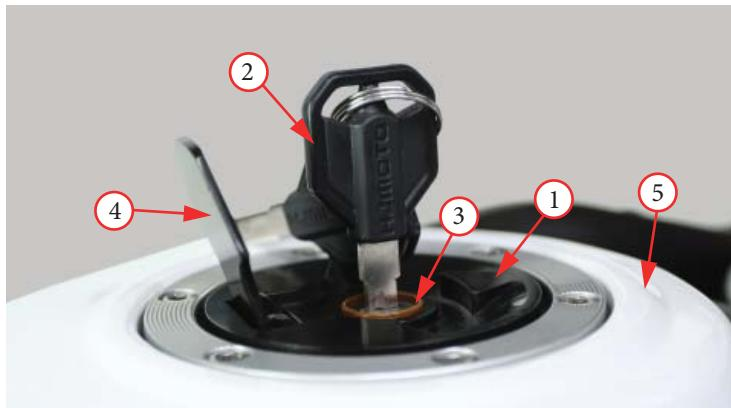
Фото 3.2. Крышка топливного бака: 1 – крышка бака;
