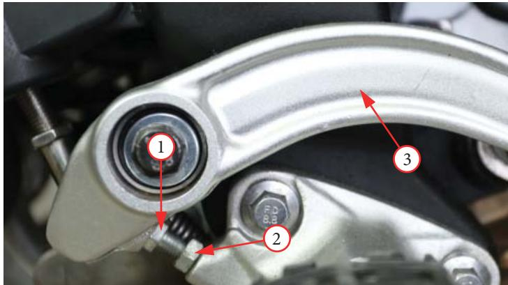
Фото 2.12. Настройка педали тормоза: 1 – регулировочная гайка;
