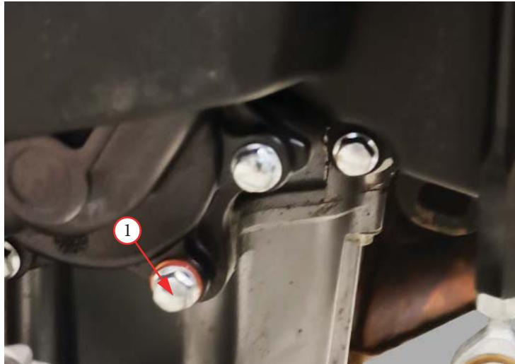
Фото 4.10. Замена охлаждающей жидкости: 1 – болт слива
