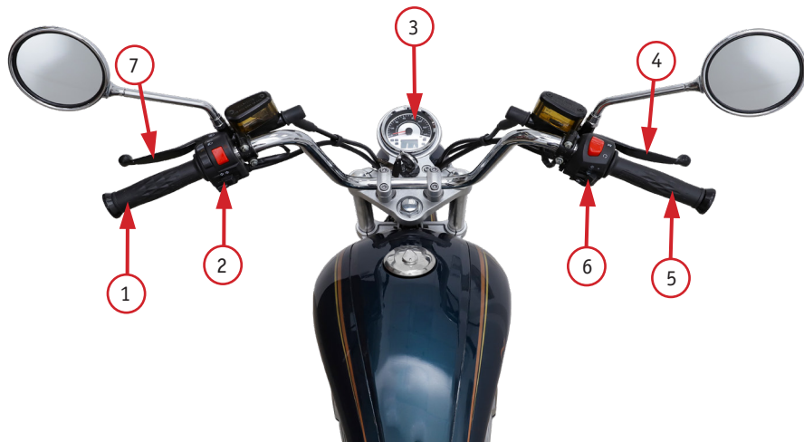
Фото 2.1. Вид руля и органов управления мотоцикла: 1 – левая рулевая рукоятка; 2 – левый комбинированный переключатель; 3 – приборная панель; 4 – правый комбинированный переключатель; 5 – рукоятка газа (акселератор); 6 – ручка переднего тормоза; 7 – ручка заднего тормоза
