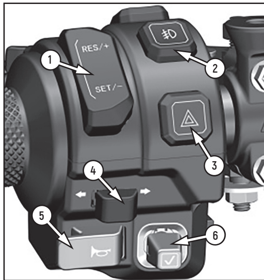
Фото 2.4 Левый блок переключателей: 1 – Переключатель круиз контроля +/SET; 2 – кнопка включения противотуманных фар; 3 – кнопка аварийной сигнализации; 4 – переключатель указателей поворота; 5 – кнопка звукового сигнала; 6 – кнопка ОК (джойстик с пятью позициями); 7 - кнопка переключения режимов света фары (дальний/ближний); 8 – кнопка открывания сиденья
