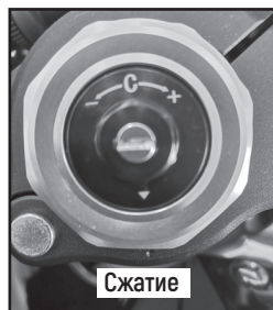
Фото 2.22 Настройка передней подвески: 1 – регулировочная гайка предварительного натяга пружины; 2 – регулировочный винт демпфирования сжатия; 3 – регулировочный винт демпфирования отбоя
