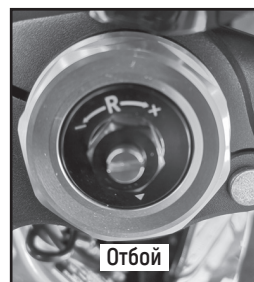
Фото 2.22 Настройка передней подвески: 1 – регулировочная гайка предварительного натяга пружины; 2 – регулировочный винт демпфирования сжатия; 3 – регулировочный винт демпфирования отбоя
