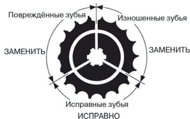
Рисунок 2. Износ звезд
