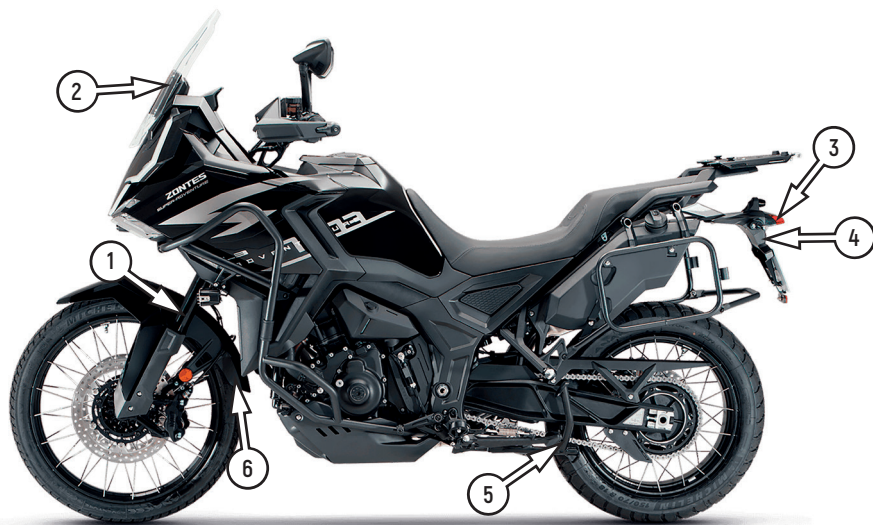
Фото 2.3 Вид слева (модель ZT703-F): 1 – передние амортизаторы; 2 – ветровое стекло; 3 – задний фонарь; 4 – заднее крыло; 5 – центральная подставка; 6 – переднее крыло
