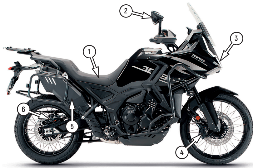
Фото 2.2 Вид справа (модель ZT703-F): 1 – сиденье; 2 – зеркало заднего вида; 3 – передняя фара; 4 – передний тормозной суппорт; 5 – глушитель; 6 – задний тормозной суппорт
