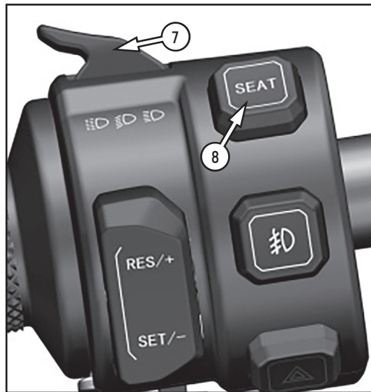
Фото 2.4 Левый блок переключателей: 1 – Переключатель круиз контроля +/SET; 2 – кнопка включения противотуманных фар; 3 – кнопка аварийной сигнализации; 4 – переключатель указателей поворота; 5 – кнопка звукового сигнала; 6 – кнопка ОК (джойстик с пятью позициями); 7 - кнопка переключения режимов света фары (дальний/ближний); 8 – кнопка открывания сиденья
