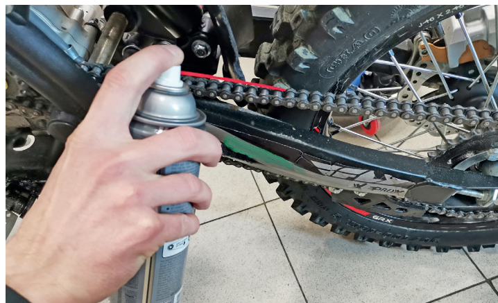
Фото 5.30. Очистка и смазка цепи
