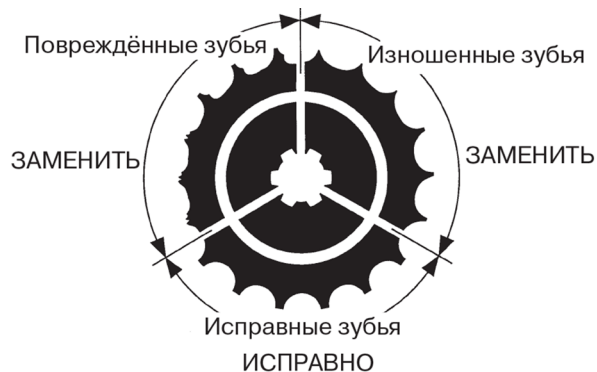
Рисунок 5.27. Вид зубьев звездочки
