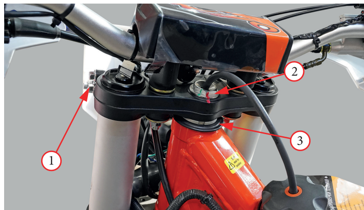
Фото 5.33. Регулировка подшипников рулевой колонки
