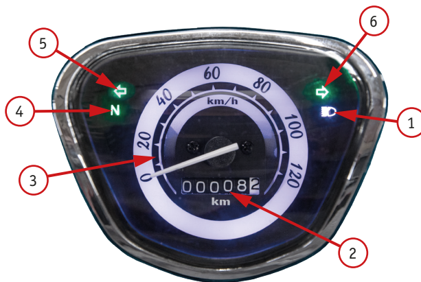
Фото 2.8. Вид приборной TFT-панели: 1 – индикатор дальнего света; 2 – одометр; 3 – спидометр; 4 – индикатор нейтрали; 5 – левый поворотник; 6 – правый поворотник
