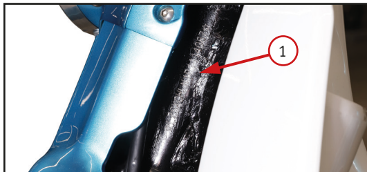
Фото 1.1. Идентификационный код транспортного средства (VIN) 1 нанесен слева на рулевом стакане
