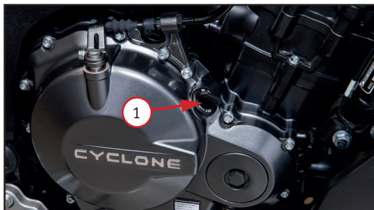
Фото 5.5. Пробка горловины для залива масла 1, болт слива масла 2
