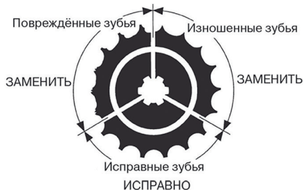
Рисунок 2. Износ звезд
