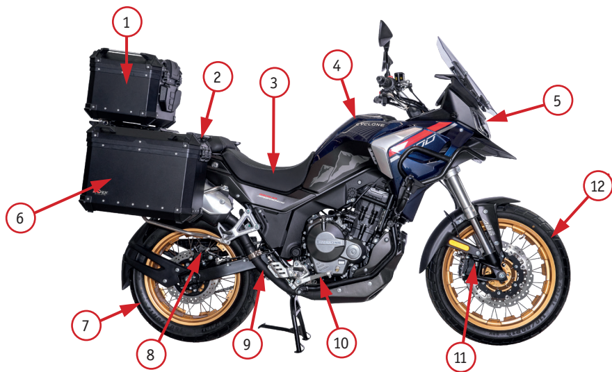
Фото 2.2. Вид мотоцикла: 1 – задний ящик; 2 – пассажирское сиденье; 3 – сиденье водителя; 4 – топливный бак; 5 – фара; 6 – боковой ящик; 7 – заднее колесо; 8 – задний тормозной суппорт; 9 – глушитель; 10 – педаль заднего тормоза; 11 – передний тормозной суппорт; 12 – переднее колесо
