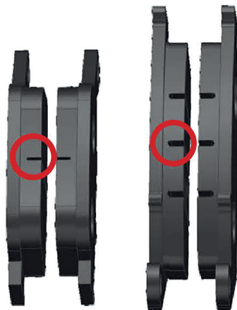
Фото 5.10. Определение износа тормозных колодок
