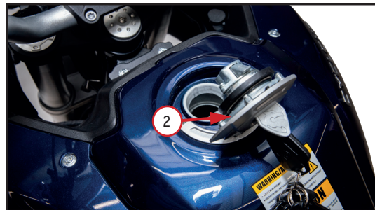
Фото 2.6. Топливный бак: 1 – замочная скважина на крышке; 2 – крышка бака открыта
