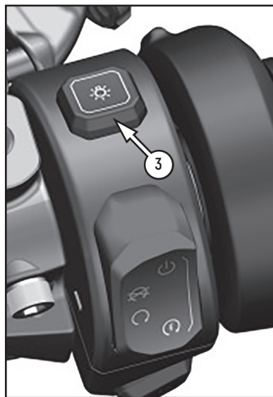
Фото 2.5. Правый блок переключателей: 1 – кнопка включения/отключения двигателя; 2 – кнопка включения режимов работы при отключенном круиз контроле; 3 – включатель света фар
