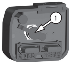
Фото 4.2. Место подключения зарядки АКБ: 1 – разъем зарядки
