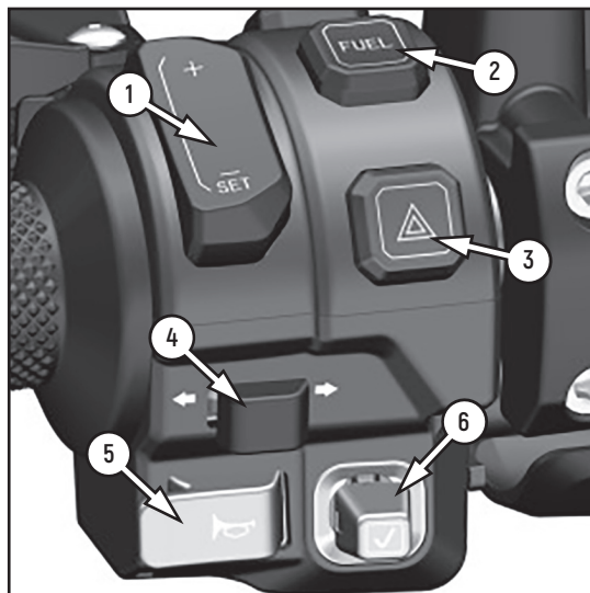
Фото 2.4. Левый блок переключателей моделей 368T-E/K/D/M: 1 – переключатель круиз-контроля «+/SET»; 2 – кнопка открывания крышки бензобака; 3 – кнопка аварийной сигнализации; 4 – переключатель указателей поворота; 5 – кнопка звукового сигнала; 6 – пятипозиционная кнопка «OK»; 7 – кнопка переключения режимов фары (дальний/ближний); 8 – кнопка открывания сиденья
