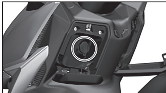
Фото 2.24. Место размещения USB- порта (модель 368T- D/M)
