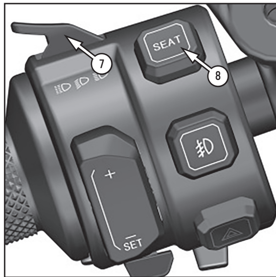
Фото 2.4.1. Левый блок переключателей модели 368E-G: 1 – переключатель круиз-контроля «+/SET»; 2 – кнопка включения противотуманных фар; 3 – кнопка аварийной сигнализации; 4 – переключатель указателей поворота; 5 – кнопка звукового сигнала; 6 – кнопка «OK»; 7 – кнопка переключения режимов света фары (дальний/ближний); 8 – кнопка открывания сиденья
